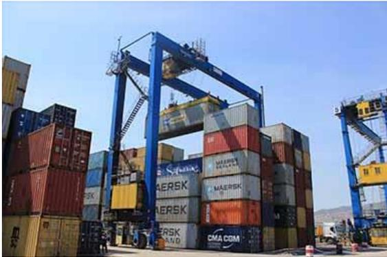
*Figure 34 : Portique gerbeur sur pneus*
