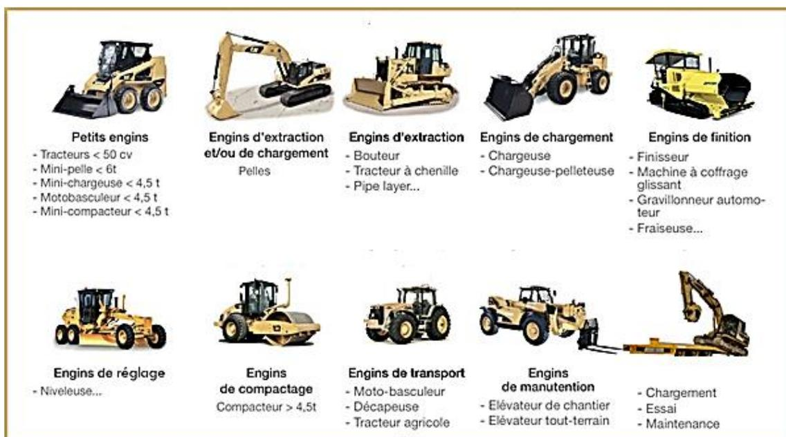
Figure 33: Classification des engins de chantier (142)
