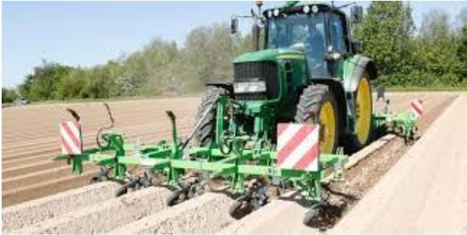
*Figure 52 : Buteuse à pompes*
