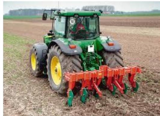
*Figure 55 : Engin agricole décompacteur*
