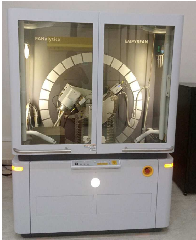
Figure II.7 : Appareil diffractomètre à rayons X type EMPYREAN PanaLytical.
