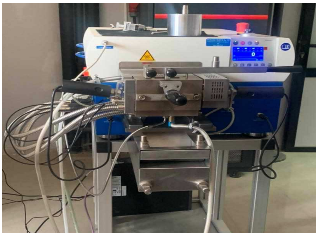
Figure II.5 : Mélangeur interne de type Bra-Bender
