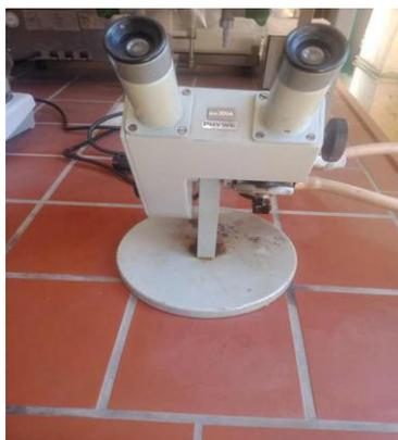
Figure II.4 : Réfractomètre.
