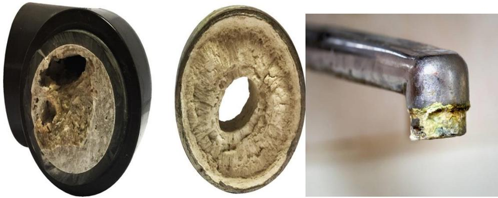
**Figure I.9** : Formation du tartre sur différentes surfaces (A.MANI et al, 2015).
