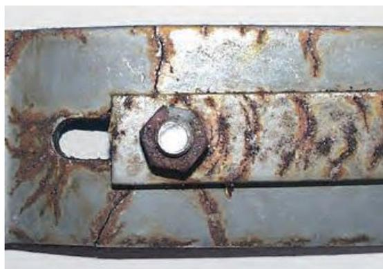
**Figure I.6 :** Fissuration par corrosion sous contrainte d'une plaque en acier, après environ 4 ans d'utilisation dans une piscine couverte [8].
