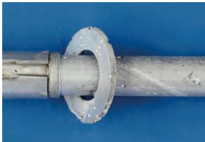
**Figure I.3 :** Exemple de corrosion par piqûres sur un produit en acier inoxydable [8].
