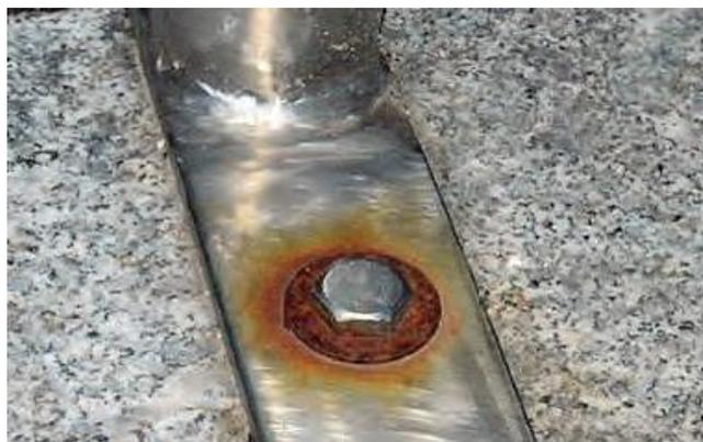
**Figure I.4:** Cas typique de corrosion de contact. Acier au carbone zingué (rondelle) et acier inoxydable (vis et pièce fixée) [8].
