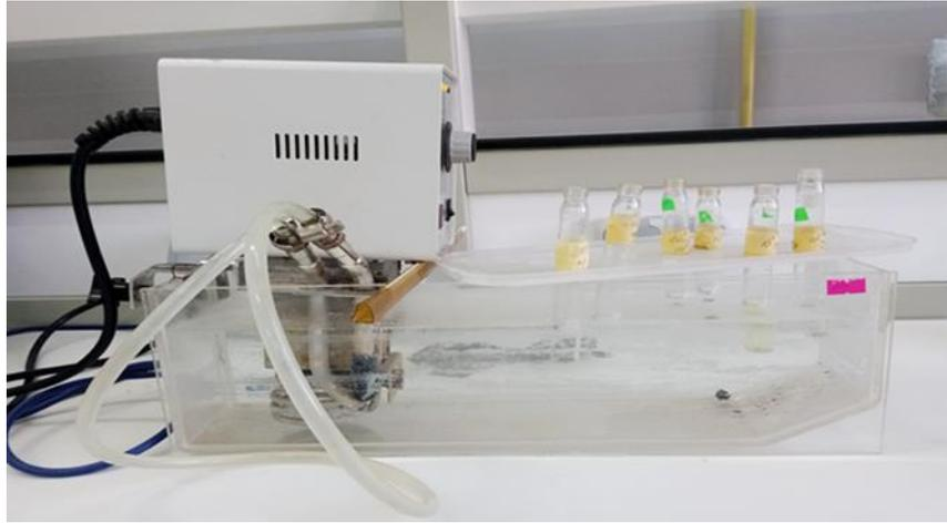
**Figure II.4 :** Montage utilisé pour les mesures gravimétriques
