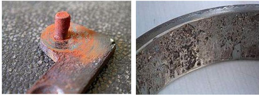
**Figure I.16 :** Corrosion par frottement
