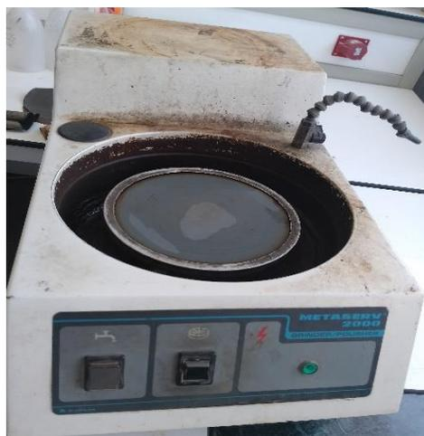
Figure II.3 : Polisseuse mécanique
