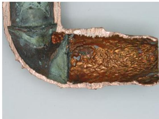
**Figure I.14 :** Corrosion-érosion d'une conduite
