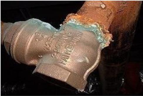
**Figure I.8 :** Corrosion galvanique résultant d'un assemblage de deux métaux différents : robinet en cuivre et conduite en acier galvanisé
