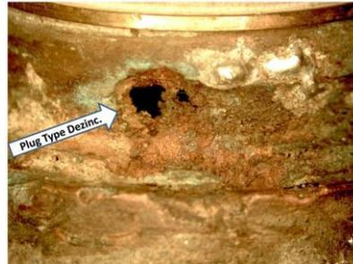
**Figure I.15 :** Dézincification du laiton
