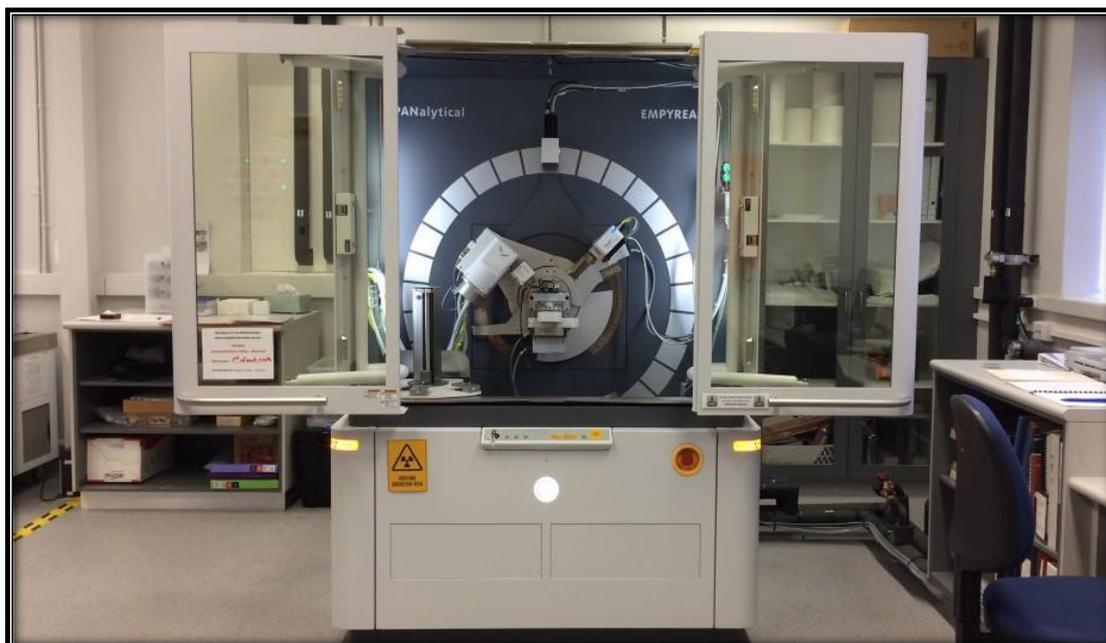
**Figure II.13** : Photographie d'un diffractomètre de type Panalytical Empyrean®.
