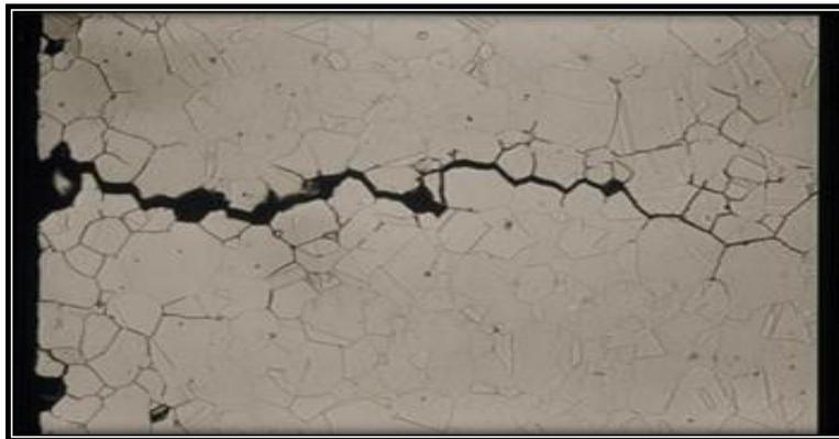
**Figure I.9 :** Corrosion sous contrainte [20].
