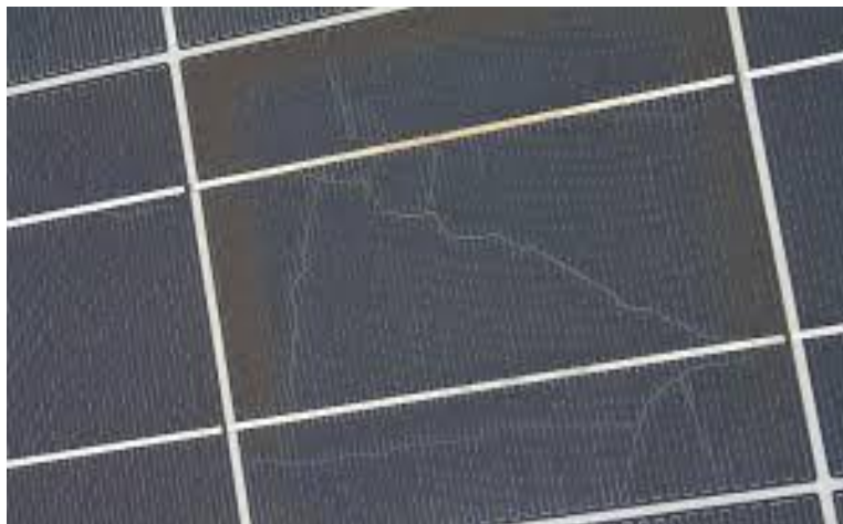
Figure II.1 : Microfissures dans les cellules solaires
