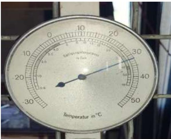
**Figure II 11:** Thermomètre à aiguille utilisé dans la mesure de température
