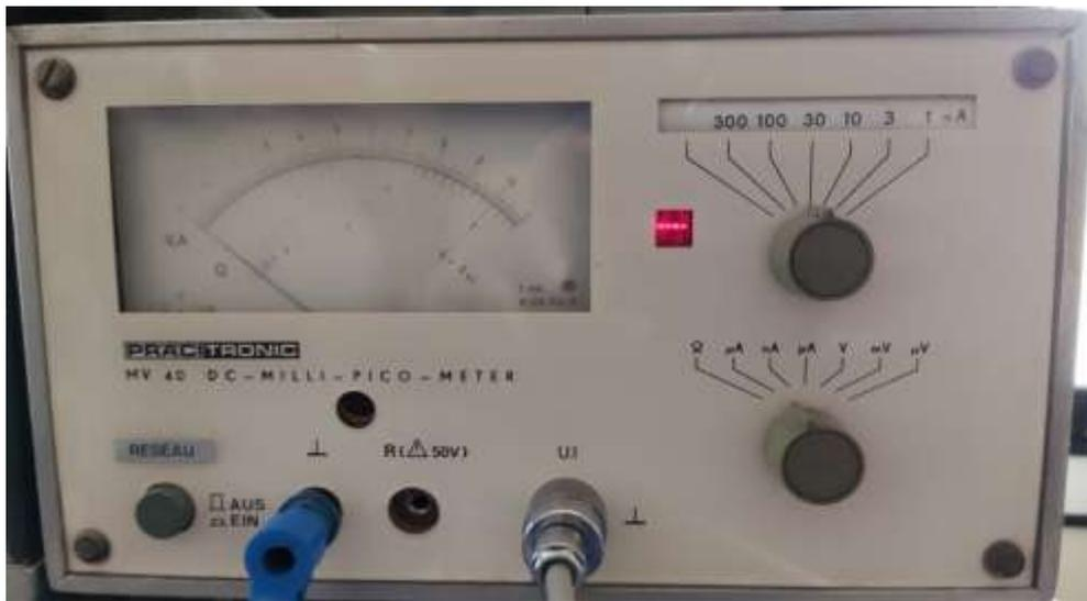
Figure II 10: Pico-ampèremètre à aiguille utilisé dans la mesure du courant de la sonde
