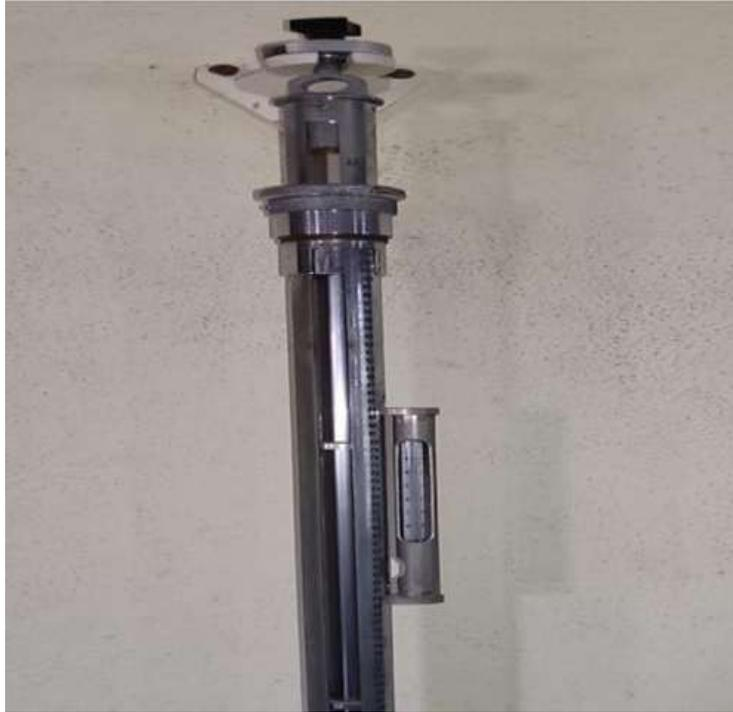
**Figure II 13:** Baromètre à mercure disponible au laboratoire
