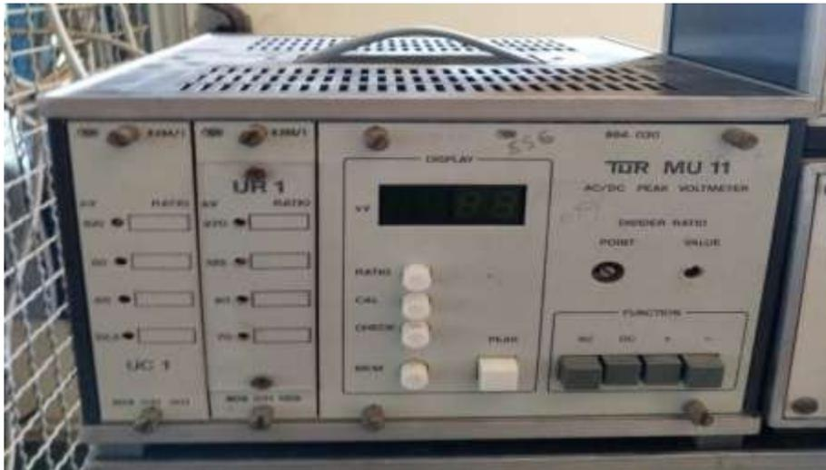
Figure II 8: Photo du voltmètre de crête
