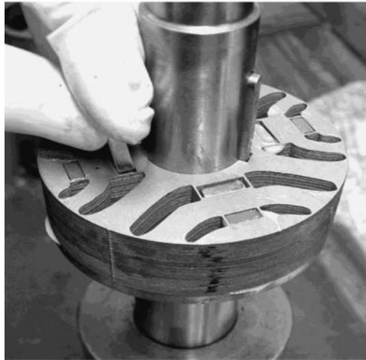
Figure IV. 1 : Machine synchrone assistée par aimant [13].
