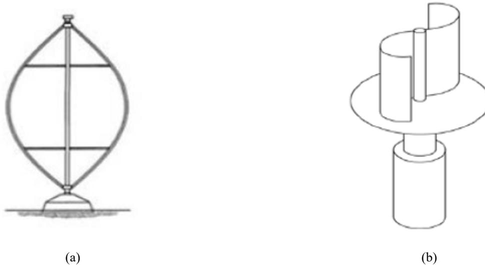
*Figure I. 2: Eolienne à axe vertical: Eolienne à axe vertical [6] (a) type Darrieus, (b) type Savonius.*
