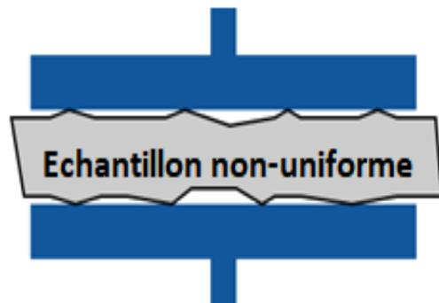
**Fig. III. 11 :** Echantillon avec surface non uniforme [150]
