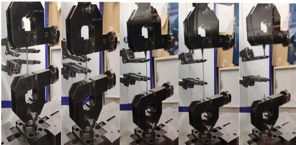
**Fig. III. 13 :** Effet de la force de traction sur l’échantillon XLR600 et son allongement jusqu’à sa rupture
