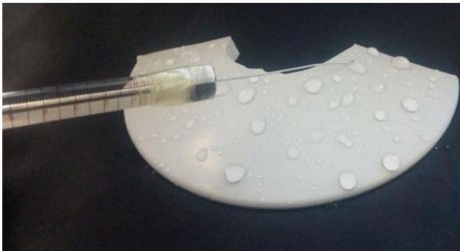
**Fig. III. 2 :** Mesure du volume des gouttes d'eau de pluie naturelle à l'aide d'une seringue graduée en microlitre
