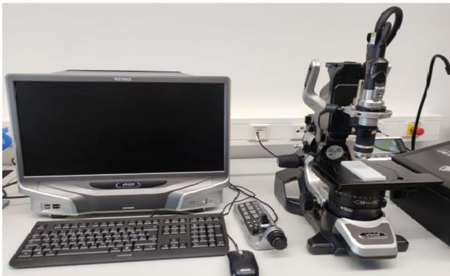
**Fig. III. 27 :** Microscope numérique, séries VHX-950F
