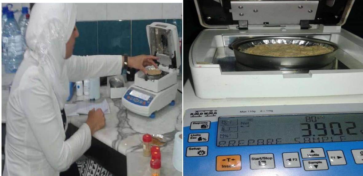
**Figure 41:** Calcul du taux d'humidité au dessiccateur allogène (RADWAG MA 110.R)
