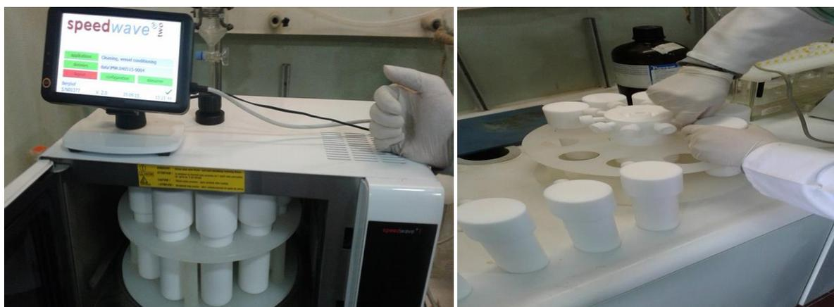
**Figure 37: conduite de la minéralisation (SPEEDWAVE TWO V.2.0)**
