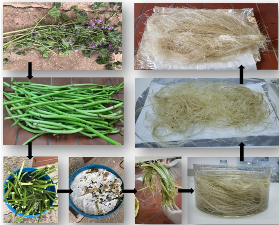
Figure II.3 : Protocole d'extraction des fibres de Malva.
