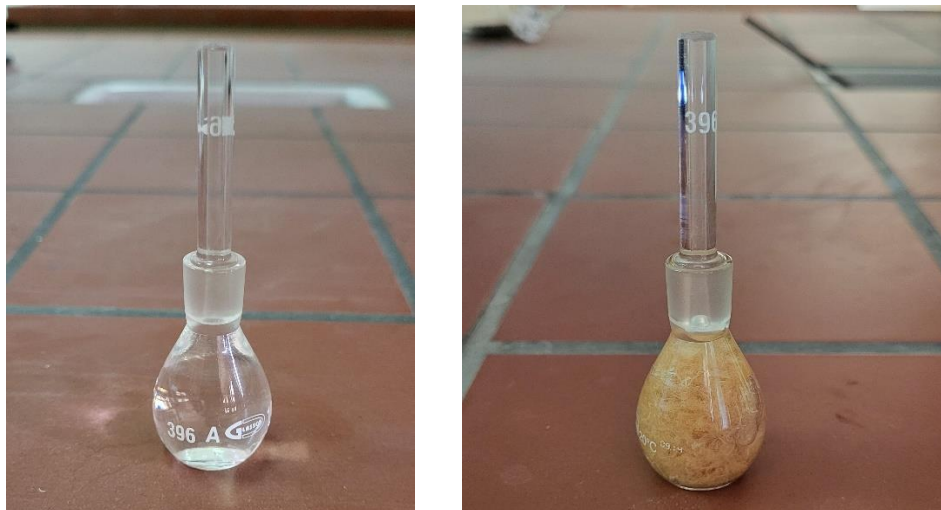
Figure II.12 : Mesure de la densité avec la méthode du pycnomètre.
