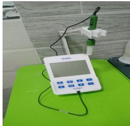
Figure 20: Dispositif d'un pH mètre
