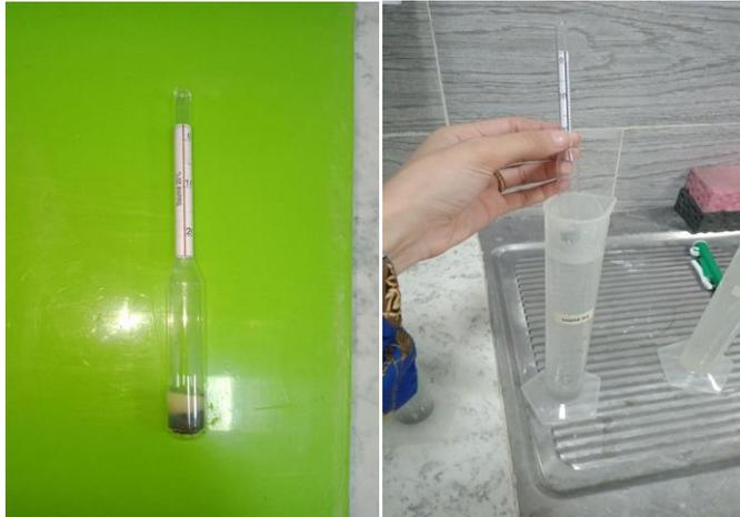
Figure 18 : Dispositif utilisé pour mesurer la densité
