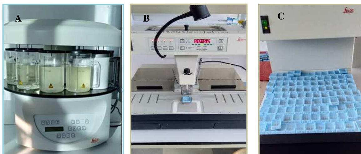
**Figure 49** : **A** : Automate de déshydratation des gonades (Rf : type LEICA); **B** : Station d'enrobage des gonades (Rf : type LEICA) ; **C** : Plaque réfrigérante des cassettes (Rf : type LEICA, EG 1150 C).
