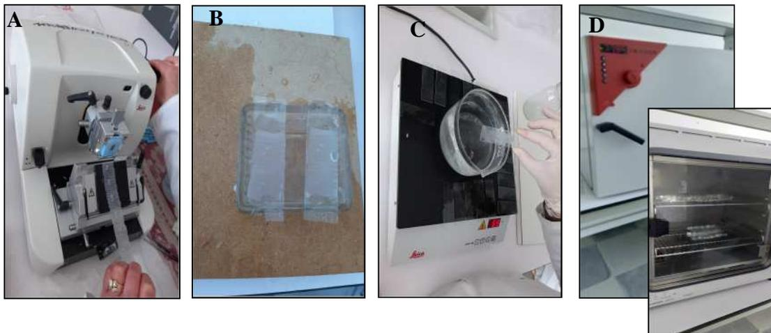
**Figure 50** : Réalisation et montages des coupes. **A**: Coupe des lames par un microtome (Réf : type LEICA). **B**: Etalement du ruban sur la lame. **C**: Déplisser lu ruban sur la plaque chauffante (Réf : type LEICA). **D**: Déparaffinage des lames dans une Etuve.
