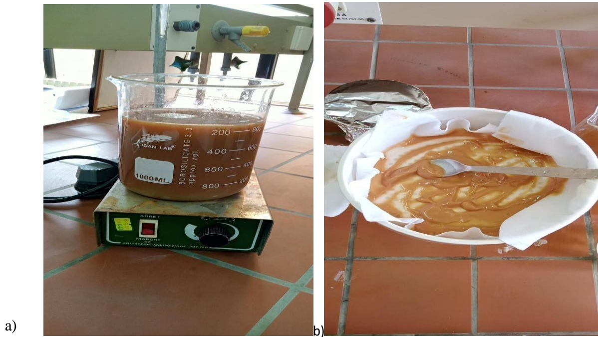
Figure II.4 : a) Le filtrat acidifié, b) La lignine filtrée.
