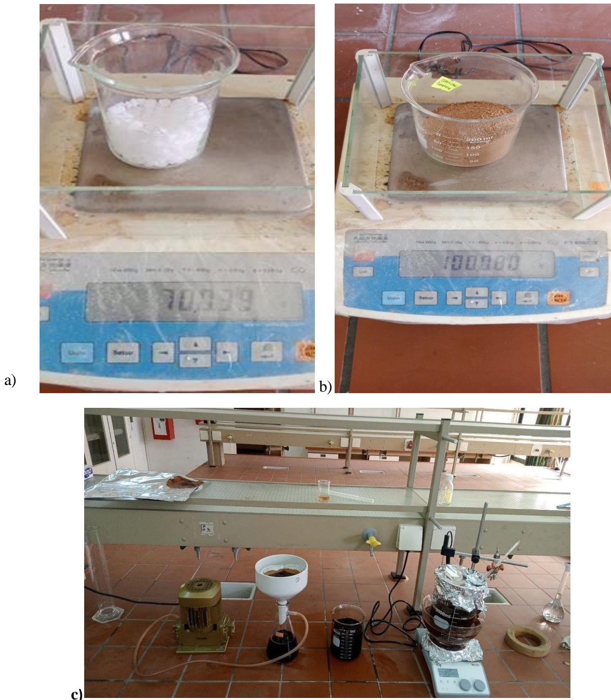
Figure II.3 : a) la pesé de KOH, b) la pesé des grignons d'olive, c) la cuisson du grignon d'olive ainsi sa filtration.
