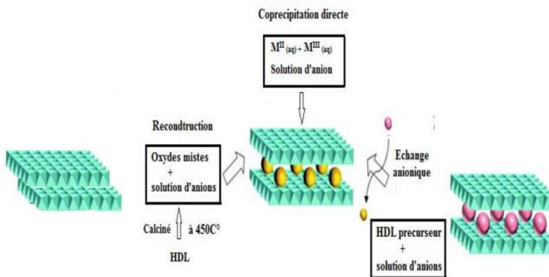
Figure (III. 5): Schéma des méthodes de synthèse usuelles des HDL [11].
