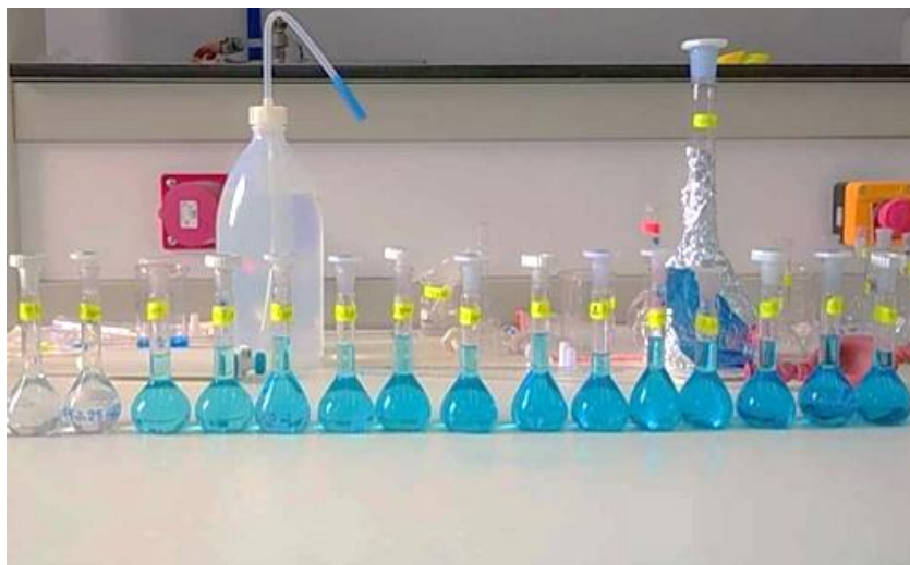
Figure (IV. 3) : Les Solutions obtenu pour la courbe d'étalonnage
