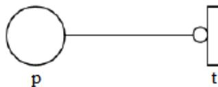
FIGURE 2.8 – RdP à arc inhibiteur.
