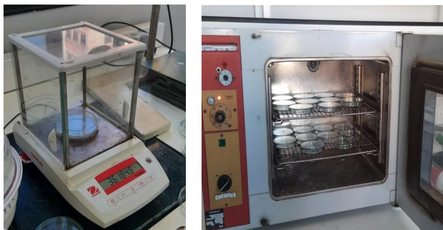
Figure 22 : Différentes étapes de la détermination du taux d'humidité de l'huile d'olive.
