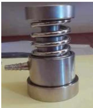
**Figure II.9 :** Placement du mélange échantillon-KBR dans le moule de presse à pastilles.
