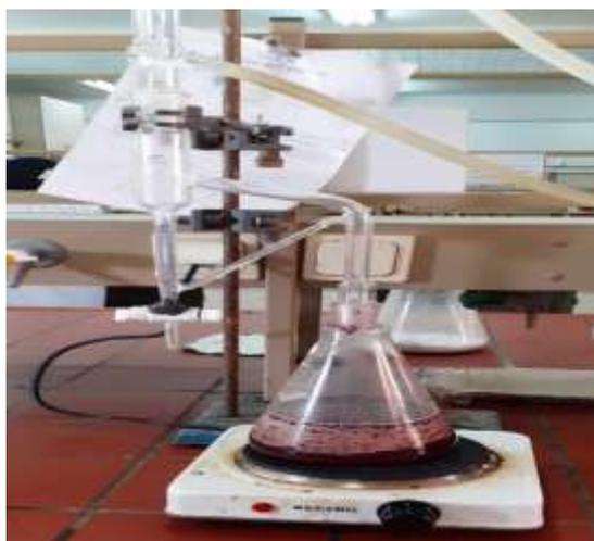
**Figure II.4 :** Montage d'extraction par hydro distillation de type clevenger
