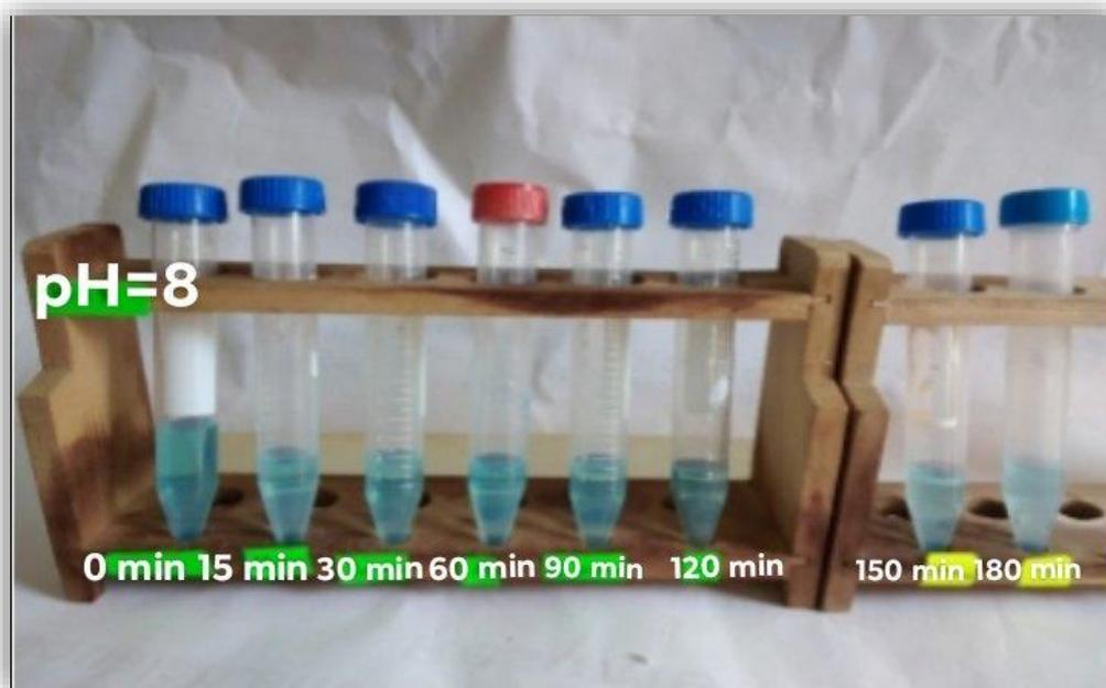
**Figure III.5** : Image de la solution de BM traité avec  $\text{CuMn}_2\text{O}_4$  pendant 3h dans l'UV.
