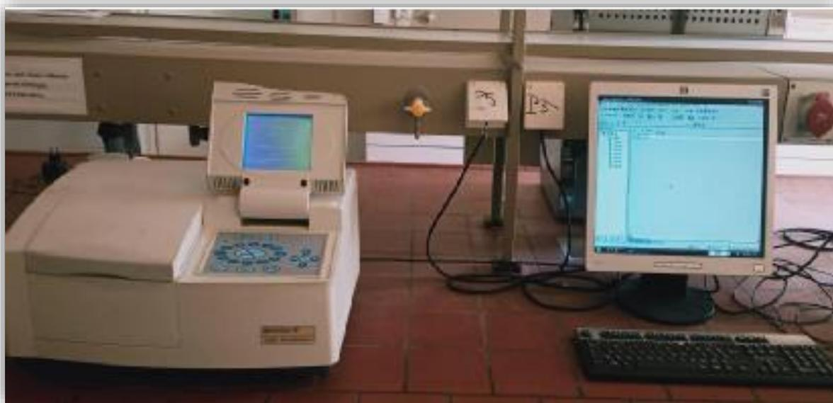
**Figure II.6 :** Le spectrophotomètre d'absorption liquide utilisé.
