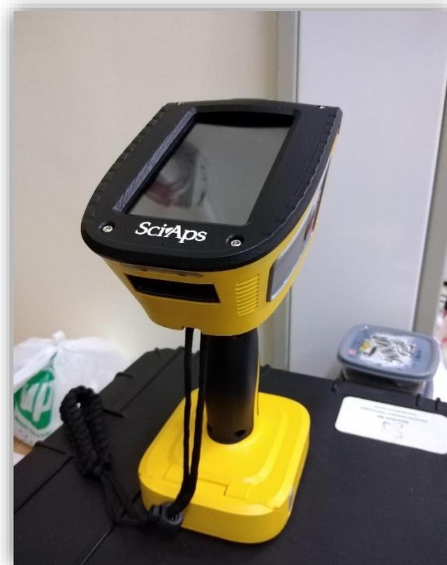
**Figure II.13** : Appareil fluorescence X (FX) utilisé.
