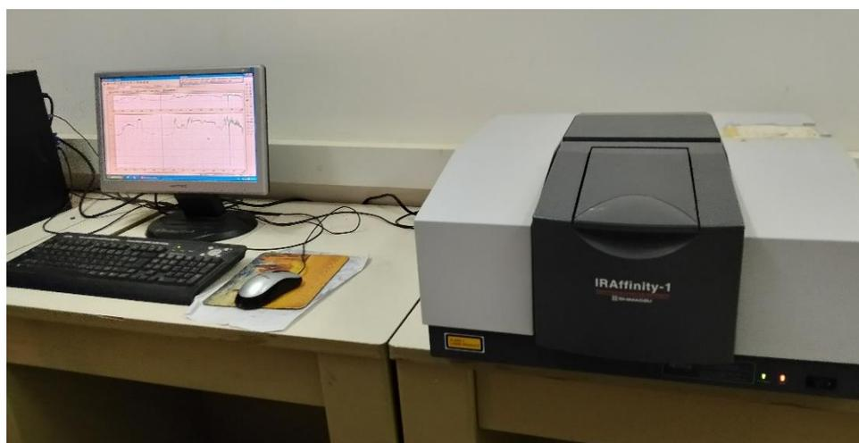
**Figure II.9 :** Spectrophotomètre IRTF.
