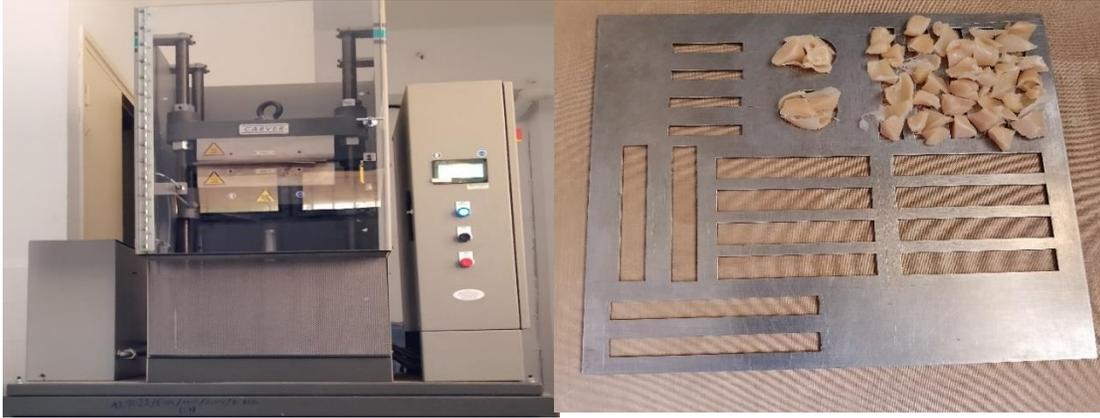
**Figure II.4 :** Presse hydraulique de type Carver Inc. 260-563-7577 X5237 avec son moule.
