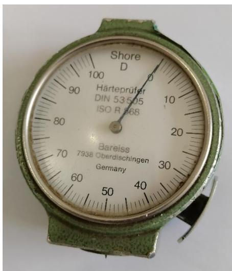
**Figure II.7 :** Duromètre shore D.
