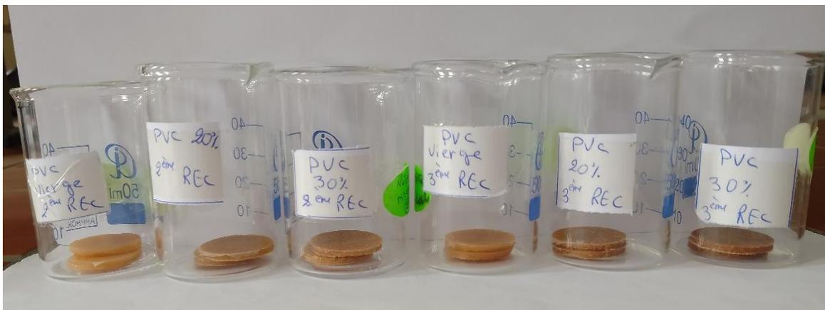
**Figure II.8 :** Test d'absorption d'eau du PVC et des différents composites.
