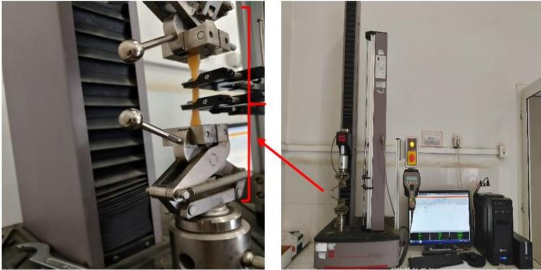
**Figure II.6 :** Dynamomètre de type MTS.
