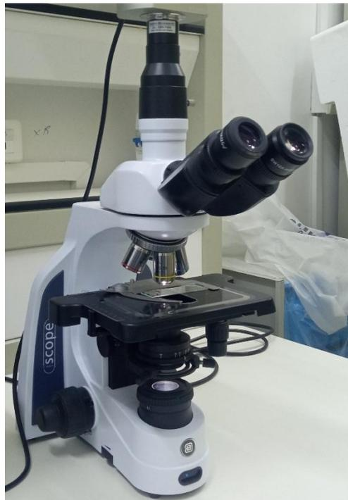
**Figure III. 10** : Microscope biologique de type iSCOPE Constrate de Phase EUROMEX.
