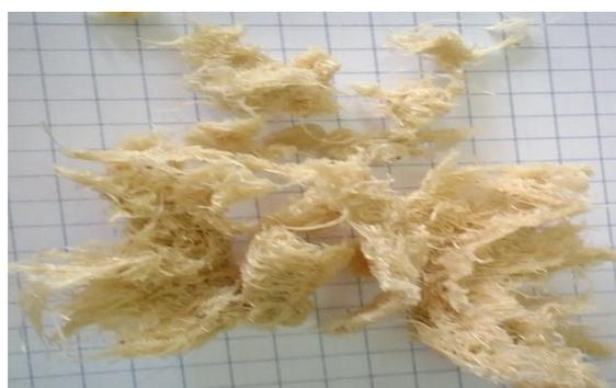
**Figure III. 3** : Les échantillons élaborés à base du PHBHHx.
