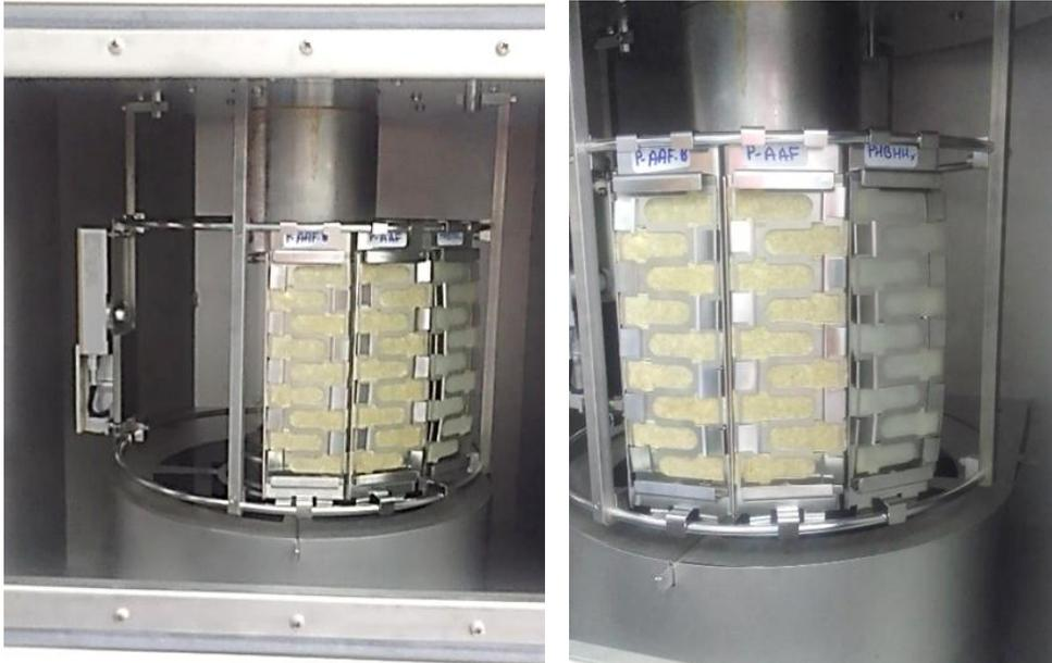
Figure III. 7 : Les porte-échantillons fixés dans la tourelle de l'enceinte.
