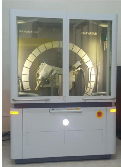
**Figure III. 13** : La machine de DRX de Empyrean Nano - Malvern Panalytical.
