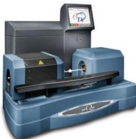
**Figure III. 12 :** Instrument d'ATG de marque SDT Q600 simultanée.
