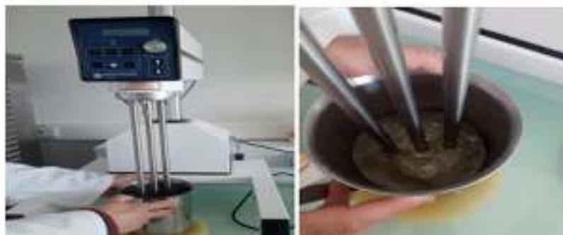
**Figure 11:** Photographies représentatives de l'enrichissement et l'agitation de l'huile avec l'agitateur High Shear.
