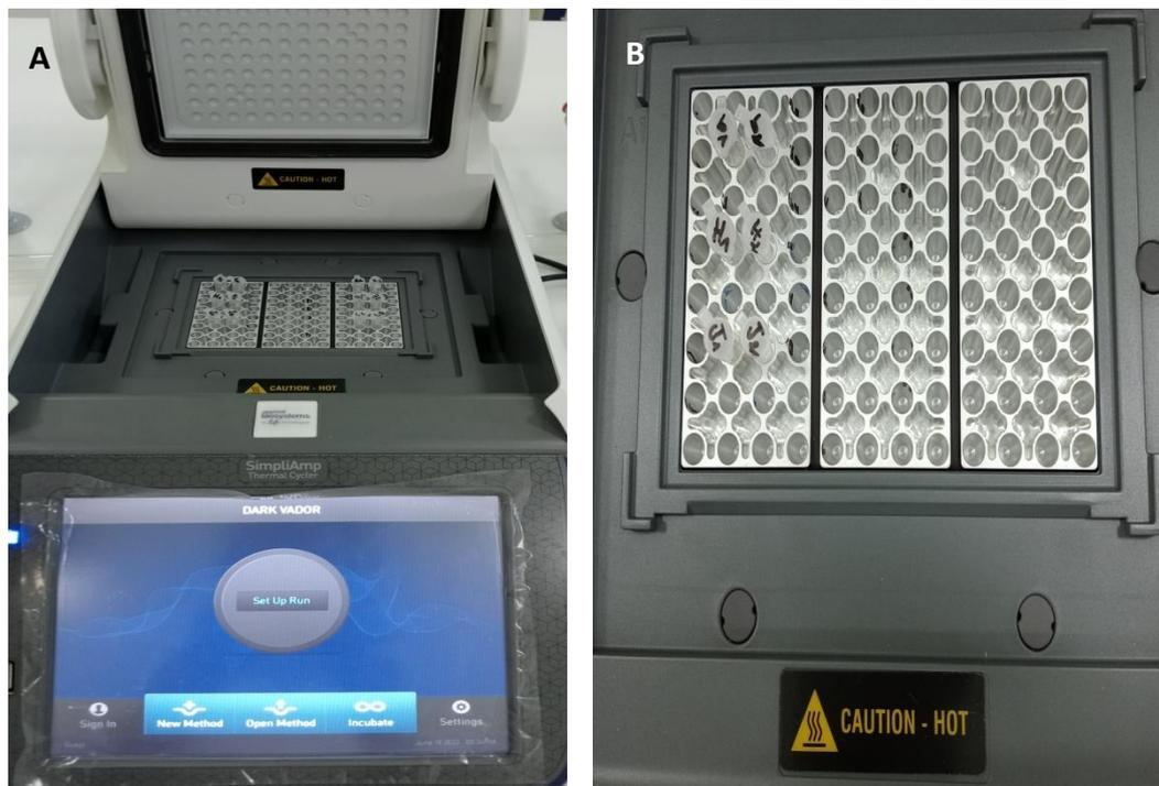
Figure 26 : (A) Thermocycleur SimpliAmp, (B) le bloc thermique (photos originales).
