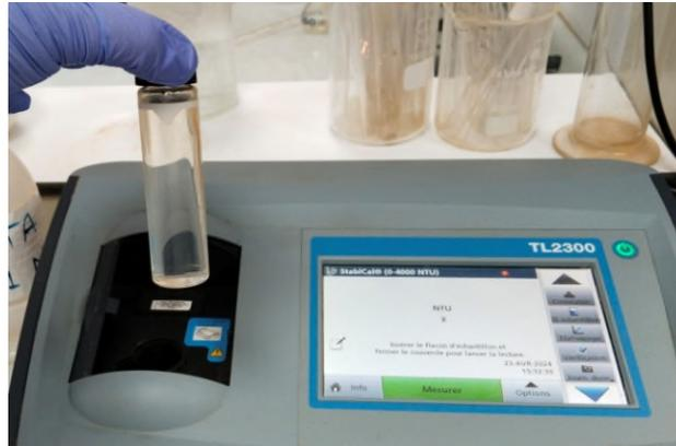
Figure II.5.2 : Turbidimètre
