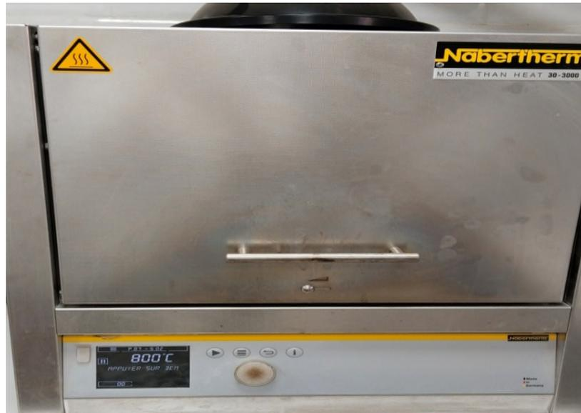
Figure II.7.4 : Four à moufle (Nabertherm de 30 à  $3000^\circ\text{C}$ )
