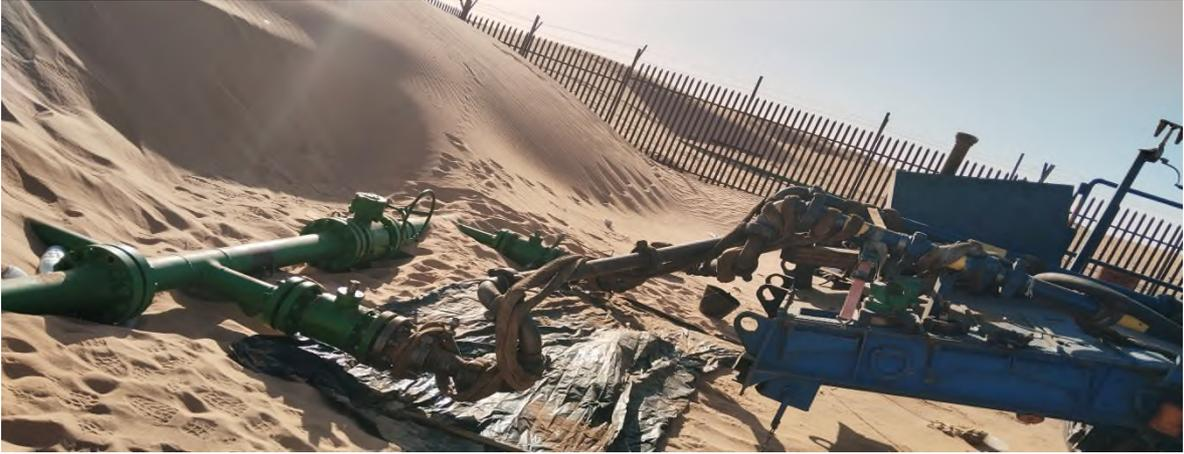
**Figure II.3.6 :** Système de déviation de pétrole brut ver le Camion.
