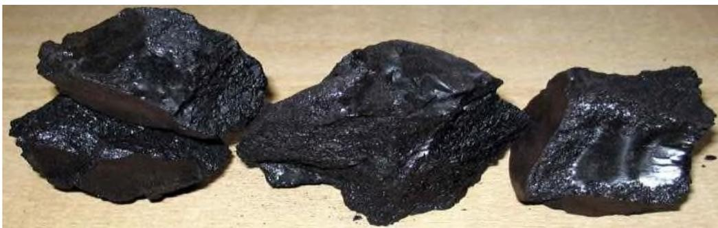
Figure I.1 : Dépôt d'asphaltène [8].
