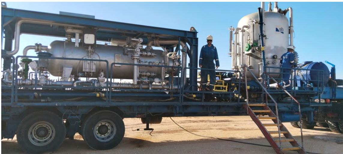
Figure II.3.5: Camion séparateur INLINE (opération de jaugage)
