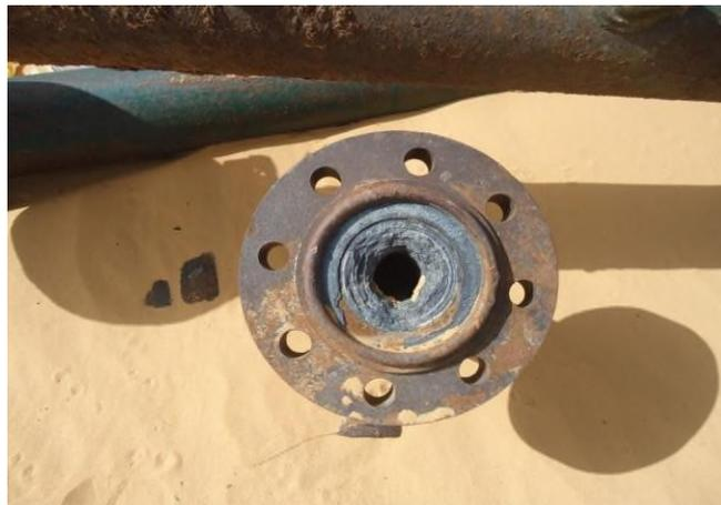
**Figure I.7 :** Dépôt de sulfate de baryum dans une conduite [11]
