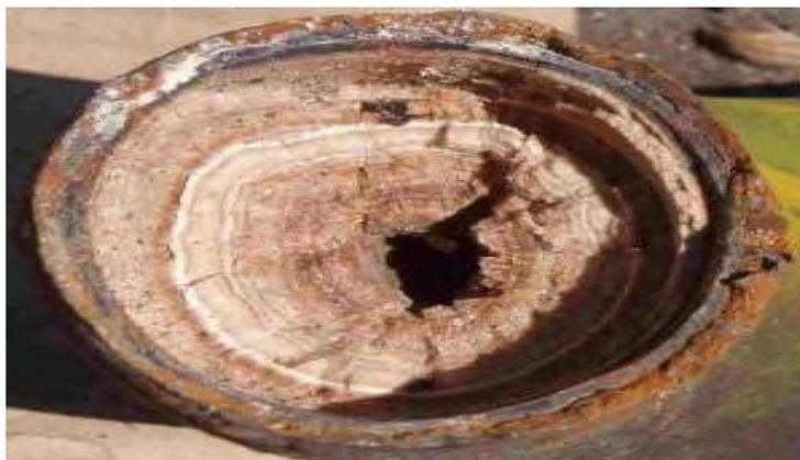
**Figure I.4 :** Dépôt de carbonate de calcium [4].
