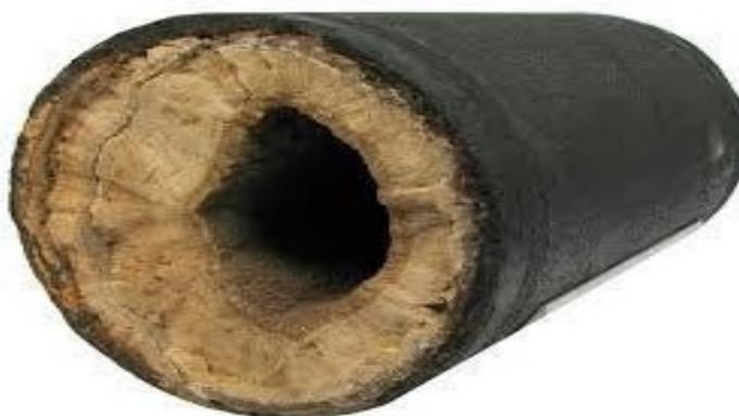
**Figure I.5 :** Dépôts de sulfate de calcium dans une conduite
