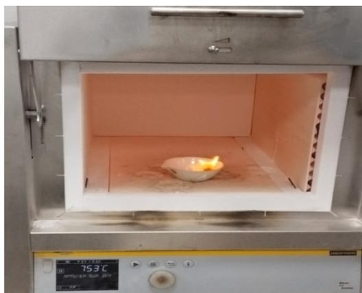
Figure II.7.5 : La fusion à  $T=900^\circ\text{C}$
