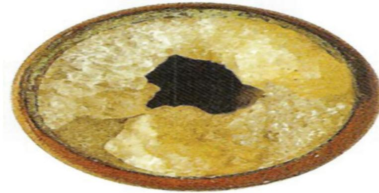
**Figure I.3:** Dépôt de chlorure de sodium(NaCl) dans une conduite[8].
