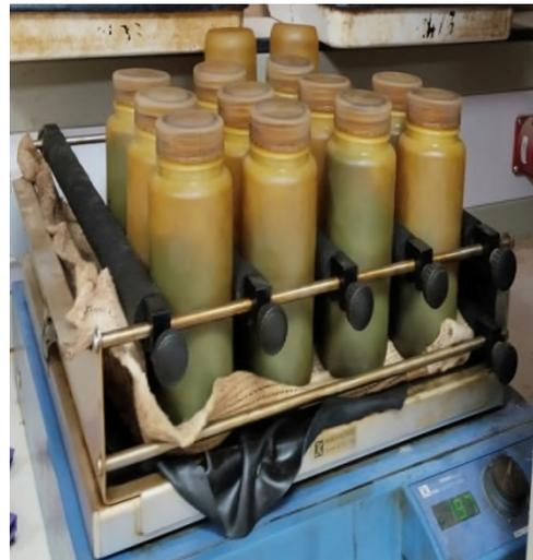
**Figure II.4.4** : Agitateur électrique
