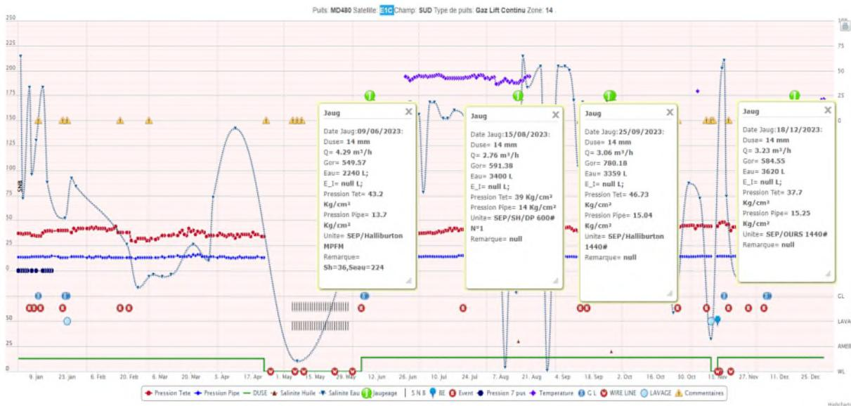
Figure III.3.1: Cahier de courbe de puits MD480
