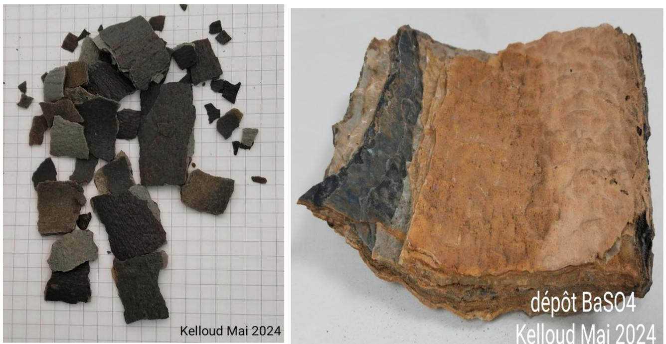
**Figure II.7 :** Dépôt du sulfate de baryum
