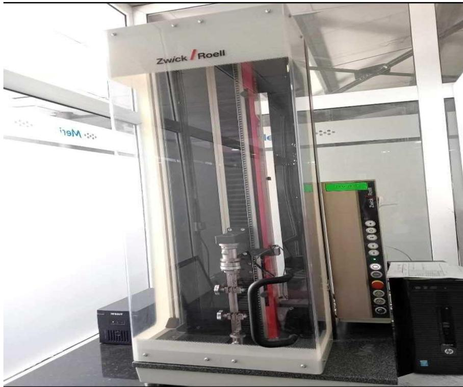
**Figure II.6:** Photographie de la machine de traction utilisée (ZwickRoell Z 0.5).
