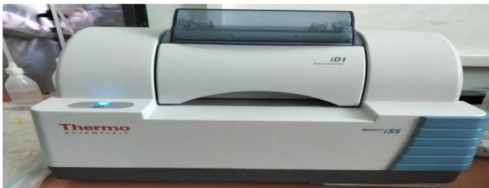
Figure II.5 : Photographie de l'appareil FT-IR ID1 Nicolet IS5 utilisée.
