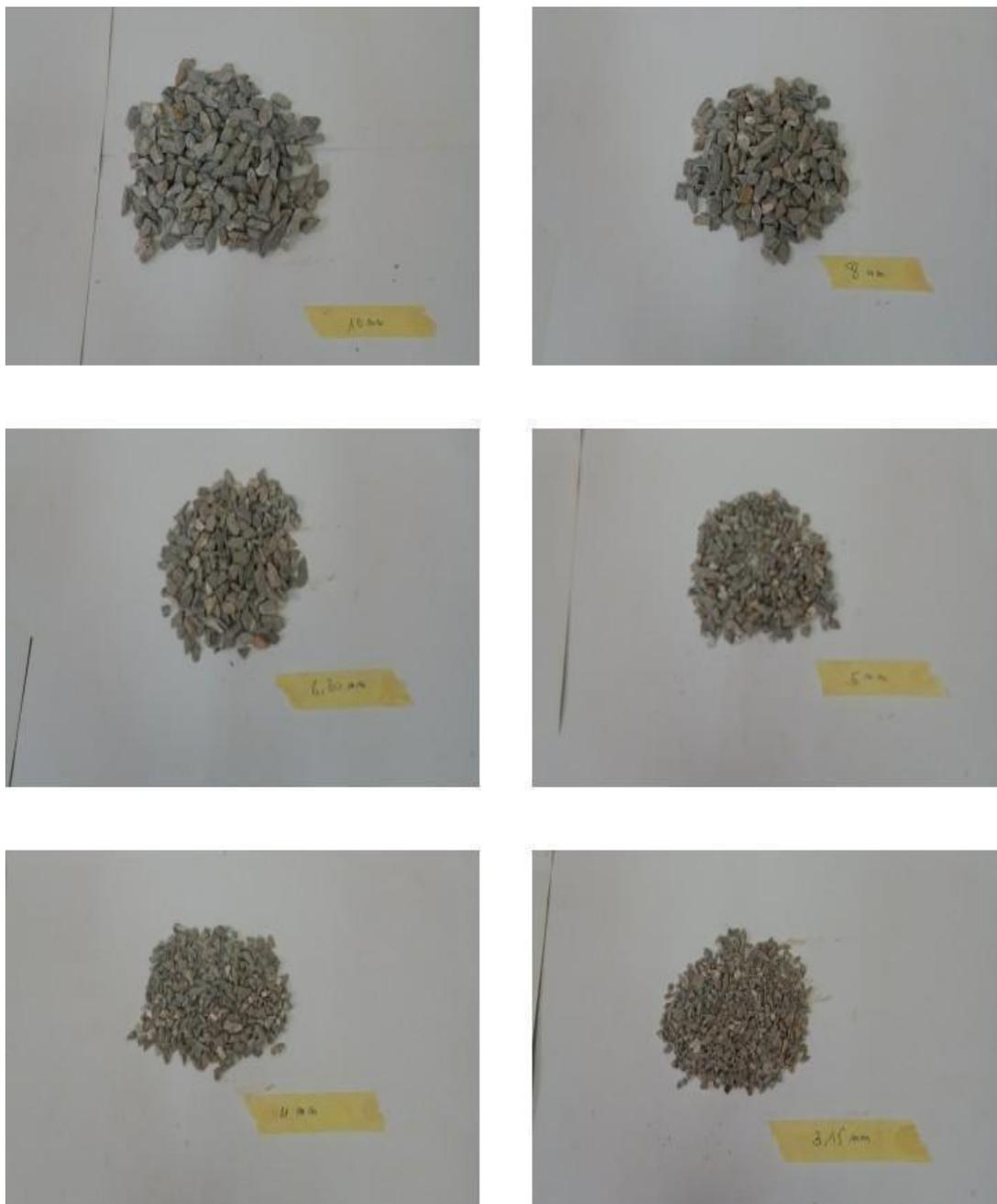
**Figure III.19:** classification obtenu (10mm à 3.15mm).
