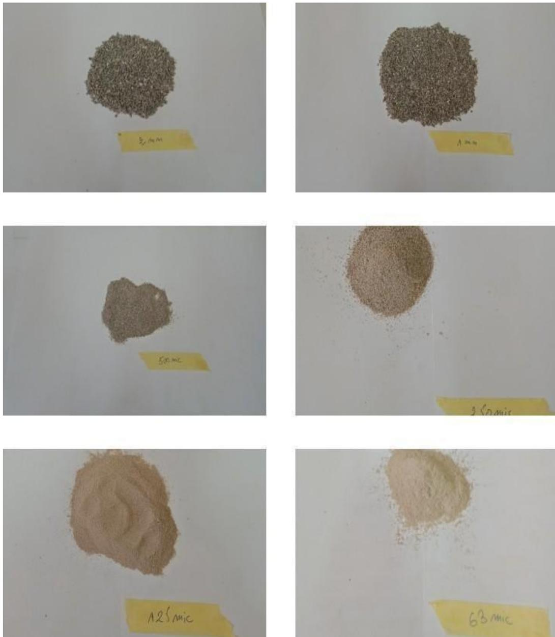
**Figure III.20:** classification obtenu (2 mm à 63  $\mu$ m).
