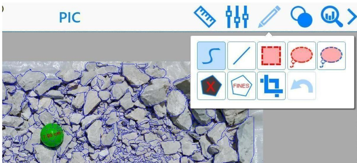
Figure III.14 : étape 3 correction manuelle de la sélection faite par WIPFRAG.
