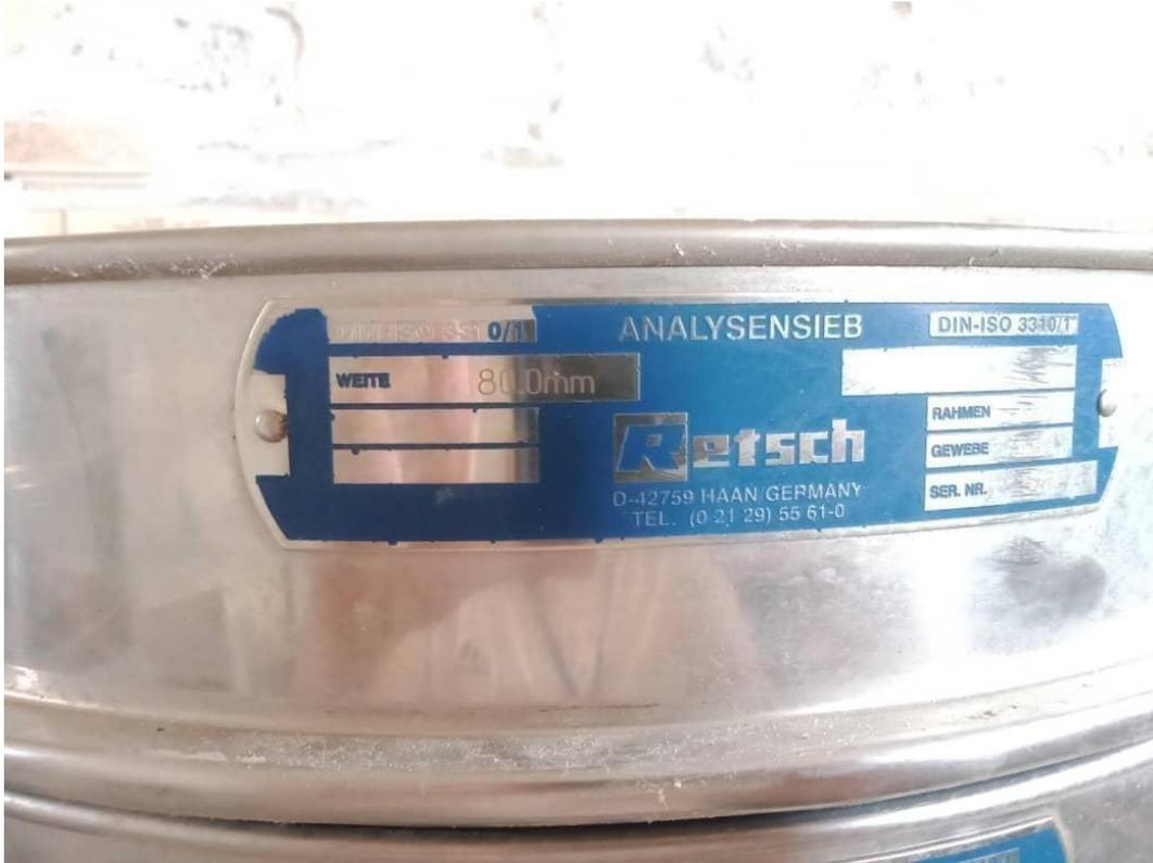
**Figure III.5** : Photo de tamis le plus grand dans le laboratoire d'Adrar-Oufernou (80 mm).
