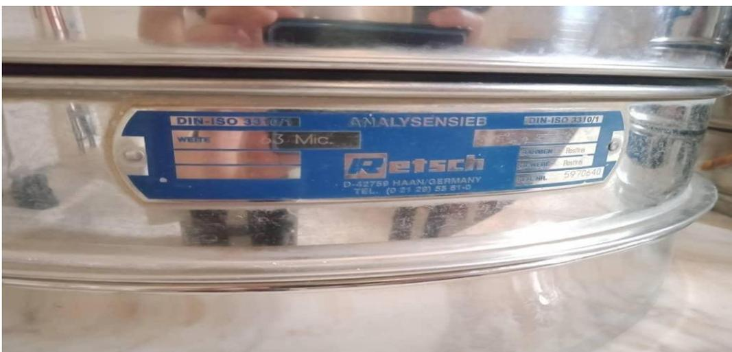
**Figure III.6** : photo du tamis le plus petit dans le laboratoire d'Adrar-Oufernou (63  $\mu$ m).
