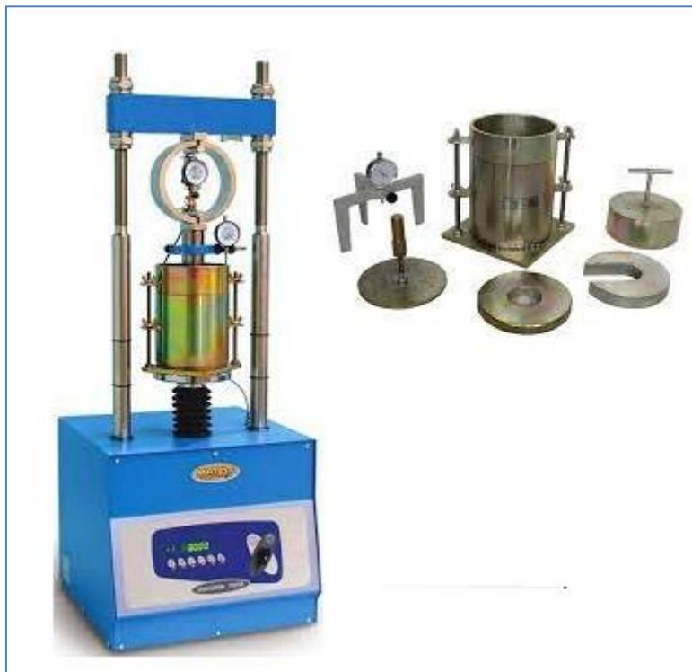
*Figure III.9 : Dispositif de l'essai CBR*
