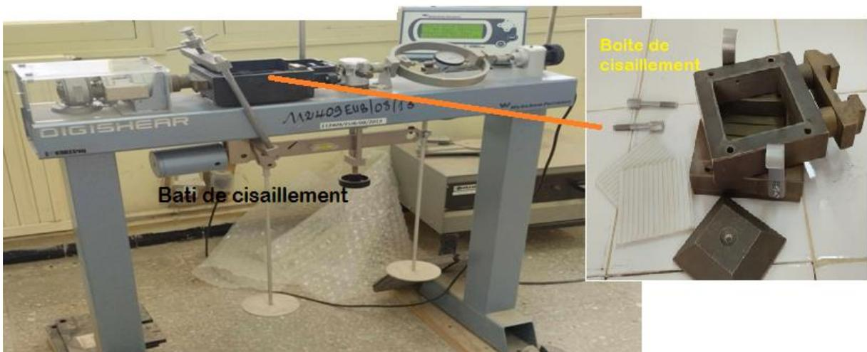
**Figure III.6 : Dispositif de cisaillement**
