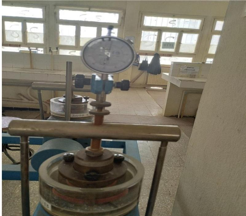
*Figure IV.28 : Essai L'œdomètre*
