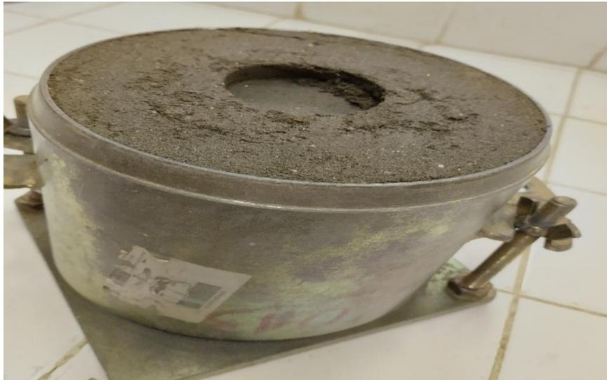
*Figure IV.23 : Sédiment +4% de ciment après essai CBR (IPI)*
