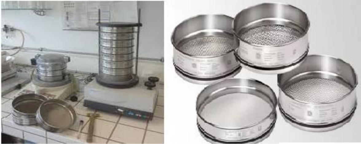
**Figure III.2 :** Dispositif utilisé dans les essais d'analyse granulométrique.
