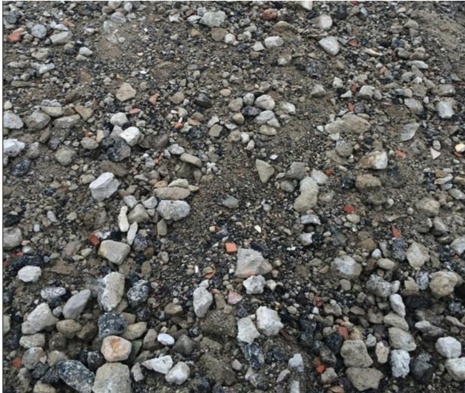
*Figure II.8 : Granulats recyclés [10]*
