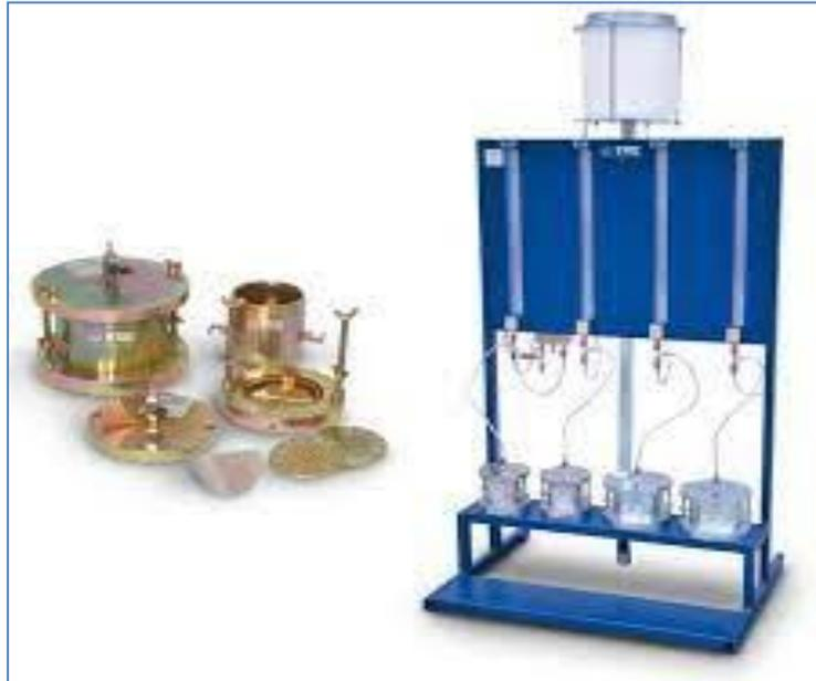
*Figure III.13 : Illustration du dispositif de mesure de Perméabilité*
