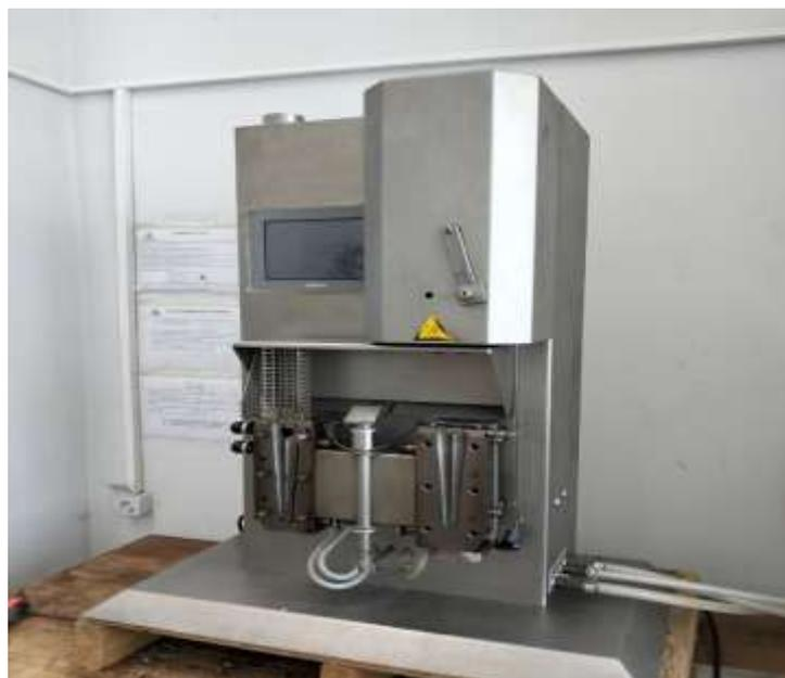
*Figure III.3 : Micro Compounder DSM, Modèle 2005.*
