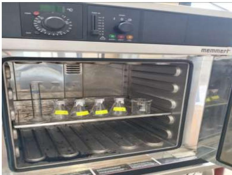
**Figure III.8 :** Préparation d'un essai de migration dans le simulant D
