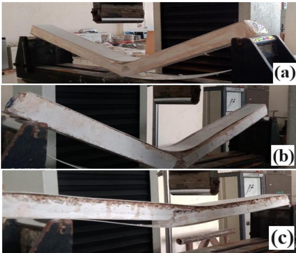
**Figure IV.20.** Modes de rupture des panneaux sous flexion : a) P-P ; b) P-PC ; c) P-FGM
