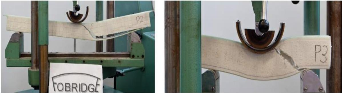
**Figure I.13.** Essais de flexion en trois points réalisé par Łukasz et Bartosz. 2020 [49].
