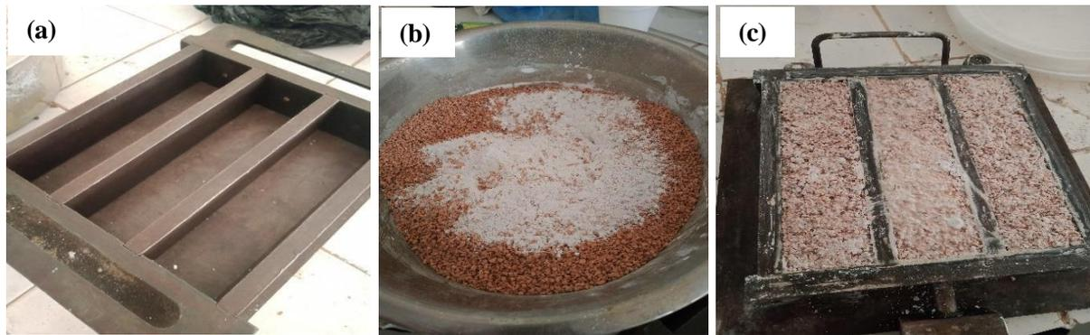
**Figure II. 17.** Les étapes suivies dans la réalisation du noyau des panneaux sandwichs : a) Préparation des moules ; b) Mélange de plâtre et de granulats du liège ; c) Moulage et coulage des éprouvettes.
