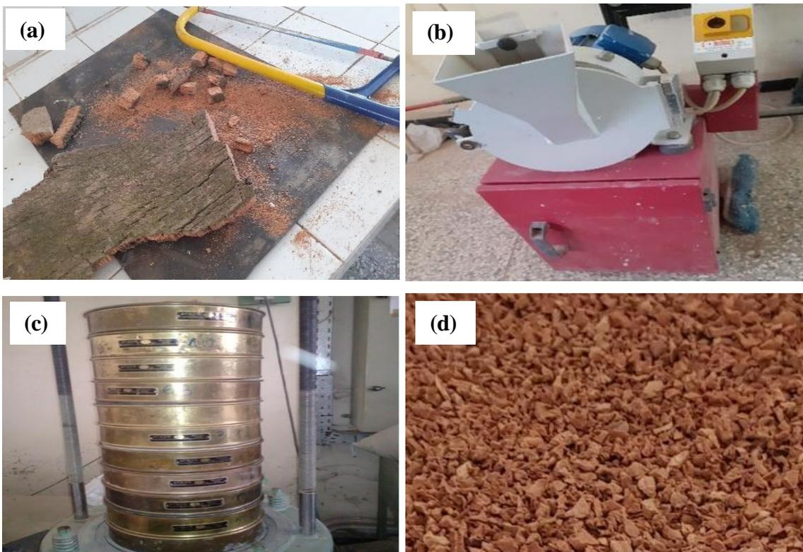
**Figure II. 7.** Traitement du liège : a) liège coupé ; b) machine de concassage ; c) Tamiseuse ; d) Granulats de liège obtenus.
