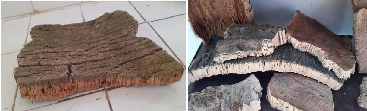
**Figure II.6.** Liège utilisé à l'état brut
