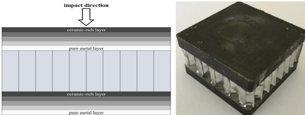
**Figure I.28.** La structure sandwich en semelle FGM produite par Arslan et Gunes [6].
