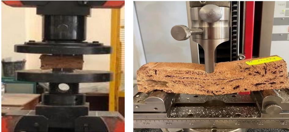
**Figure II.10.** Essai sur liège : a) Essais de compression ; b) Essais de flexion 3-points
