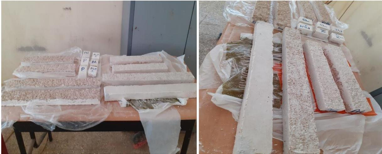
**Figure II.21.** L'ensemble des éprouvettes d'âme des panneaux sandwichs
