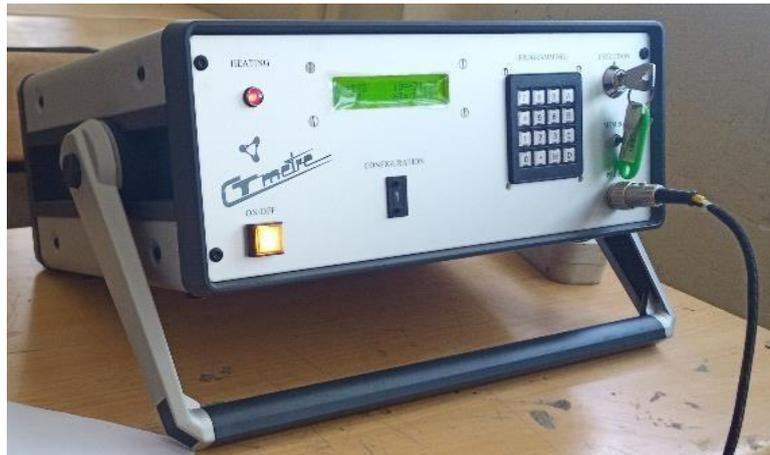
**Figure II.9.** Le CT-mètre utilisé pour mesurer la conductivité
