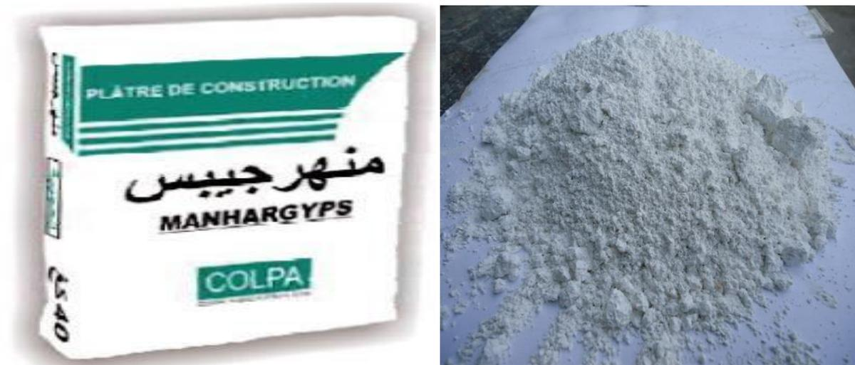
Figure II.2. Le plâtre (Manhargyps) utilisé
