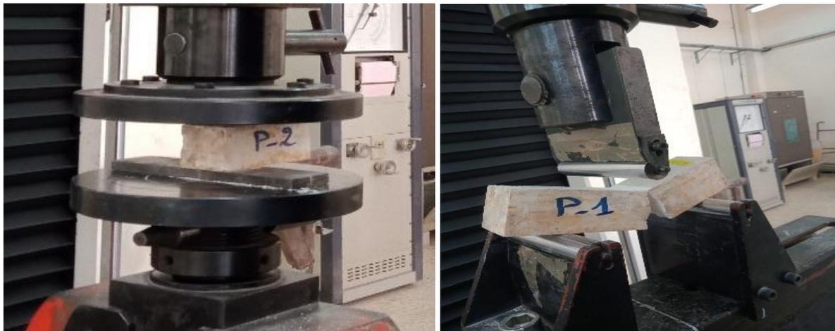
Figure II.3. Mode d'essai sur le plâtre : a) Essais de compression ; b) Essais de flexion à 3 points
