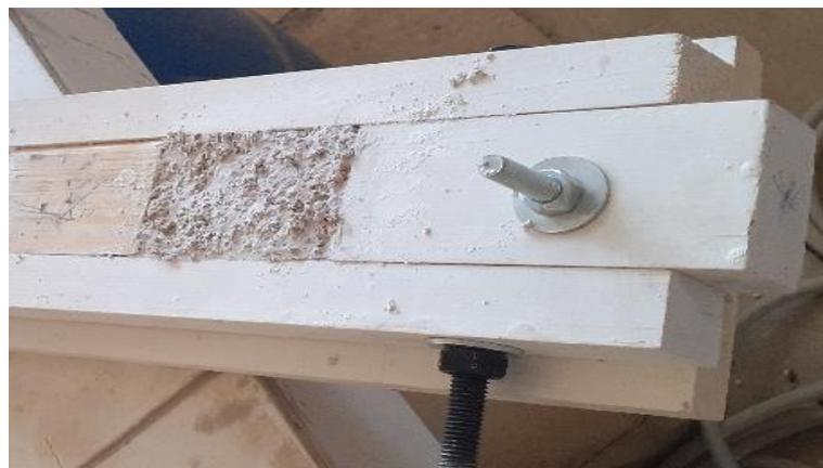
**Figure II.19.** Eprouvette coulée dans le moule en bois
