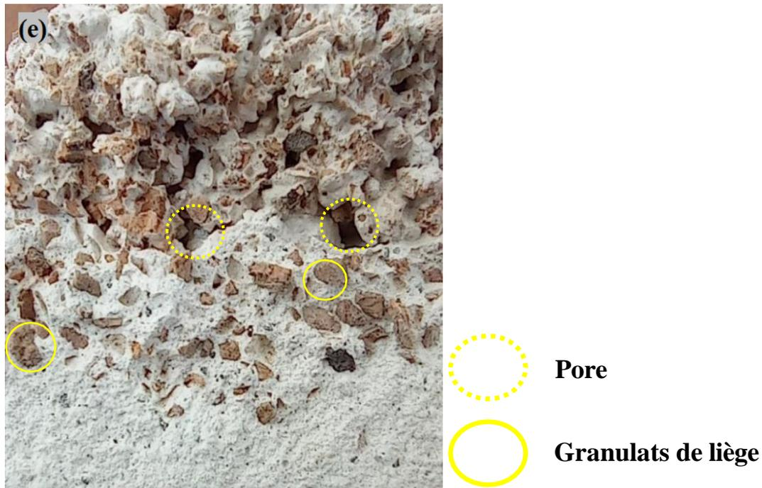
**Figure III.5.** Vue macroscopique des sections transversales centrales des panneaux sandwichs : a) P-P ; b) P-PC ; c) FGM-2 ; d) FGM-1 et e) FGM-3
