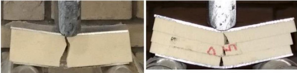
**Figure I.14.** Une comparaison de l'effondrement expérimental des poutres sandwichs multicouches testées par M. Kazemi [4].
