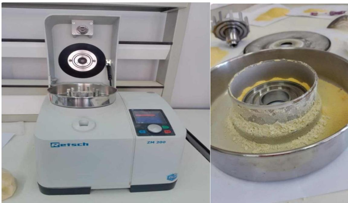
**Figure II.4:**Photo de la machine du broyage et tamisage.
