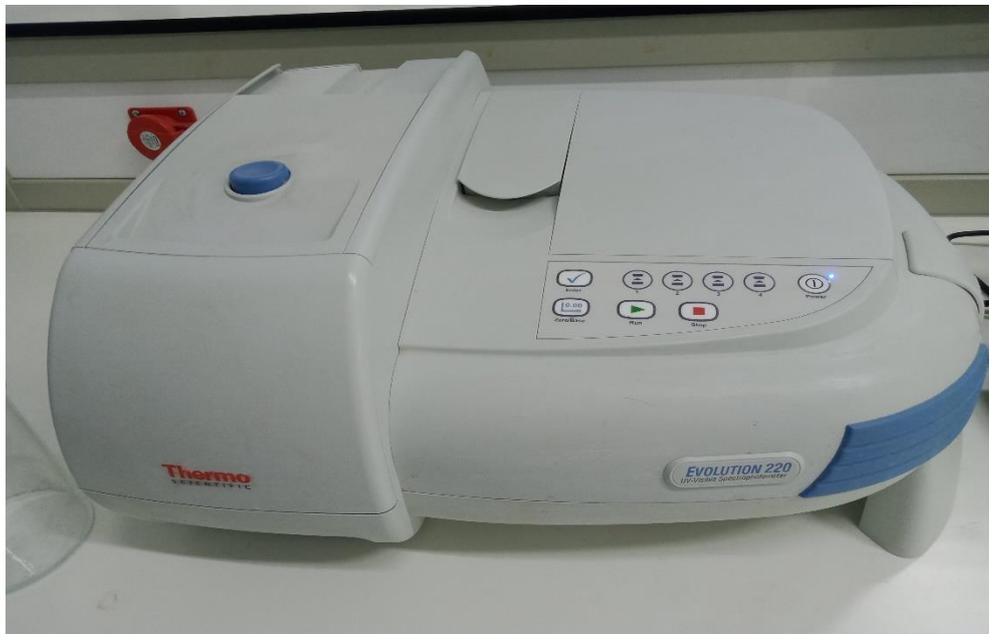
**Figure IV-4** : La spectrophotomètre UV-visible
