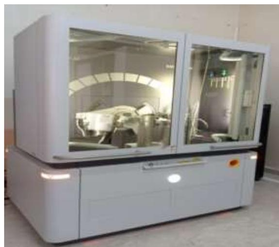
**Figure II.5.** Diffractomètre utilisé pour la diffraction des rayons X.
