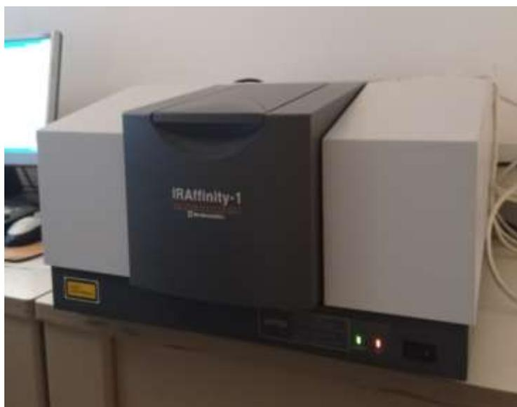
**Figure II.10.** Appareil IR Affinity-1 utilisé pour la caractérisation des poudres récupérées par CBD.
