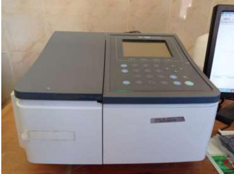
**Fig. II.7.** Appareil UV-visible utilisé pour la caractérisation.
