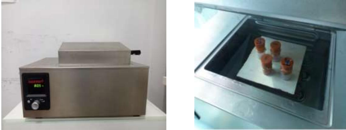
**Figure I.2.** Déposition des films de ZnS par bain chimique.
