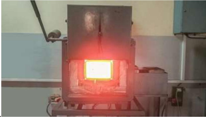
Figure II.2 : Four électrique disponible au laboratoire Fonderie du département génie mécanique au niveau du hall de technologie.
