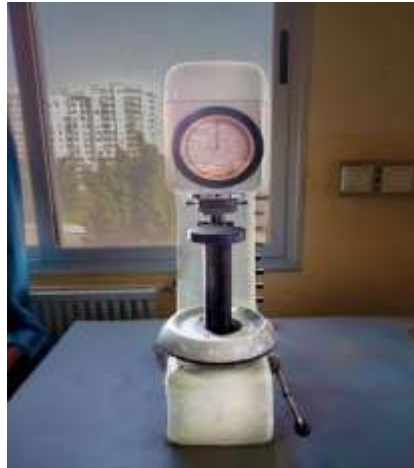
Figure II.6 : Machine de dureté universelle Brinell, Vickers et Rockwell.
