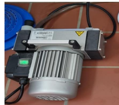
Figure A.2.9 : Pompe sous-vide (Bloc 9)
