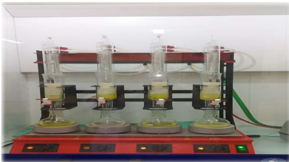
Figure 3: Extraction de l'huile de P. lentiscus par Soxhlet (photo originale).
