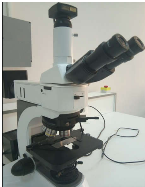
Figure II.16: Microscope optique Model NMM-820TRF, équipé d'une caméra TOUPCAM (UCMOS08000KPB)
