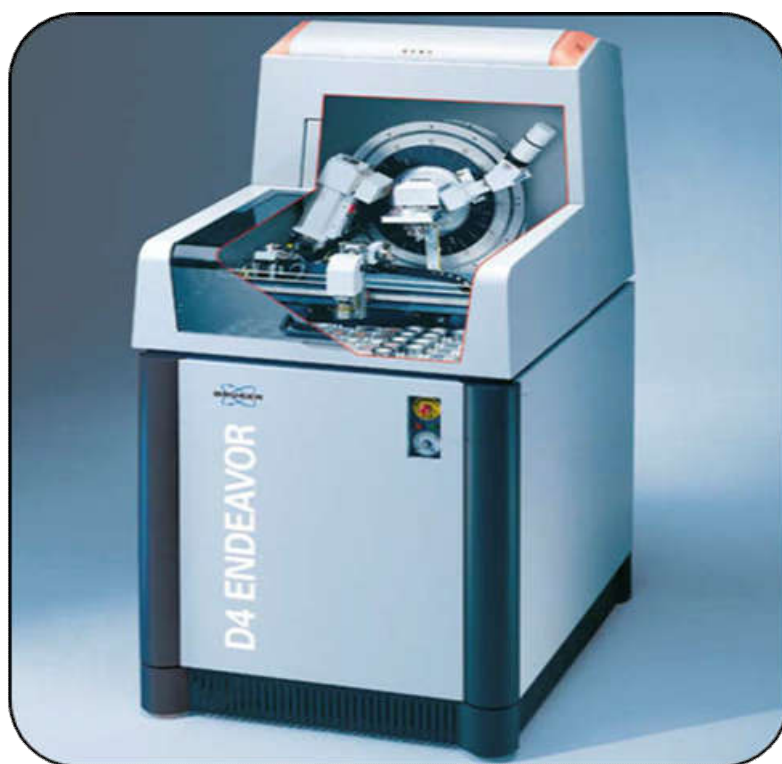
Figure II.13: Schéma de dispositif de DRX (D4 ENDEAVOR)
