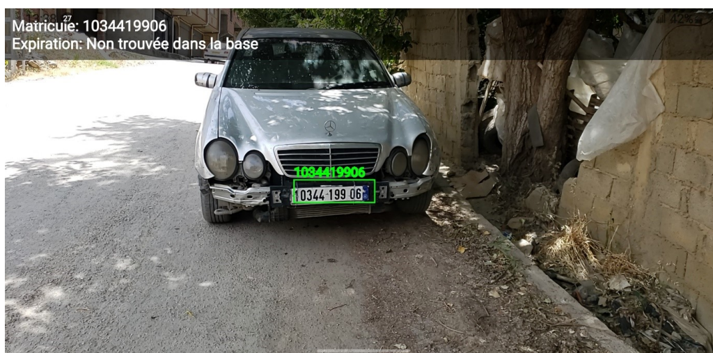
FIGURE 4.17 – Détection de la plaque dans l'interface de détection de l'application sur téléphone
