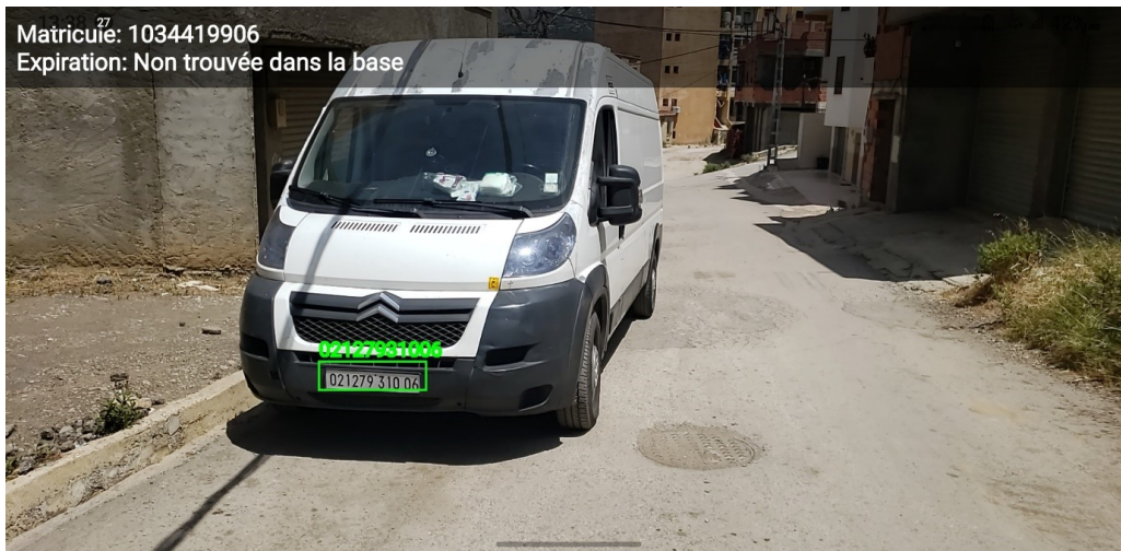
FIGURE 4.18 – Capture 9 – Détection de la plaque dans l’interface de détection de l’application sur téléphone
