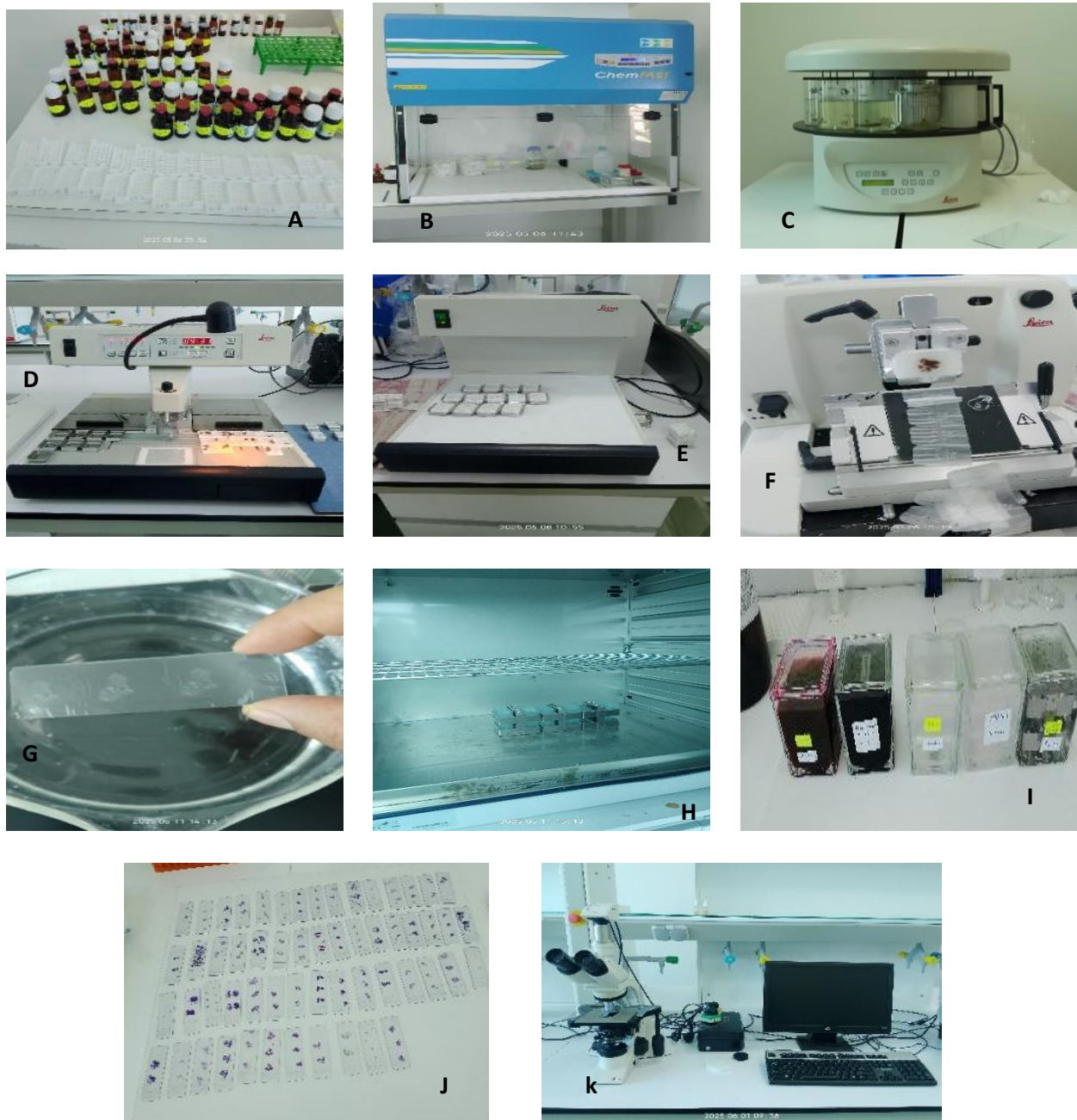
Figure 12: les étapes des coupes histologiques. A : Identification des histo-cassettes et préparation des échantillons. B : hotte chimique. C : automate de déshydratation. D : station d'enrobage. E : plaque réfrigérante. F : microtome. G : L'étalement des segments de ruban de paraffine sur les lames de verre. H : déparaffiner à l'étuve. I : Coloration standard. J : le montage. k : microscope optique doté d'une caméra
