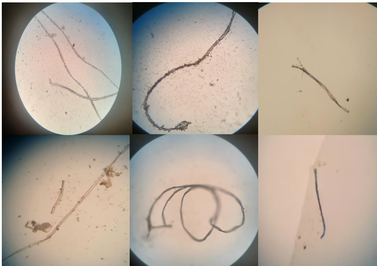
Figure III.6 – Observation des MP et MF du site 01 (S.A.L) au microscope optique (G x 40) (photos originales).
