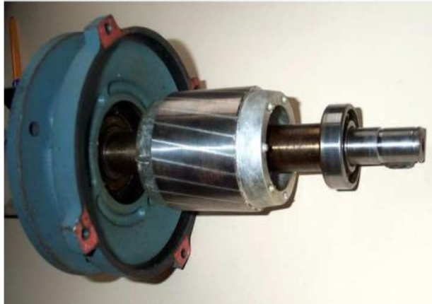
Figure I.3: Rotor d'une machine asynchrone a cage [19].
