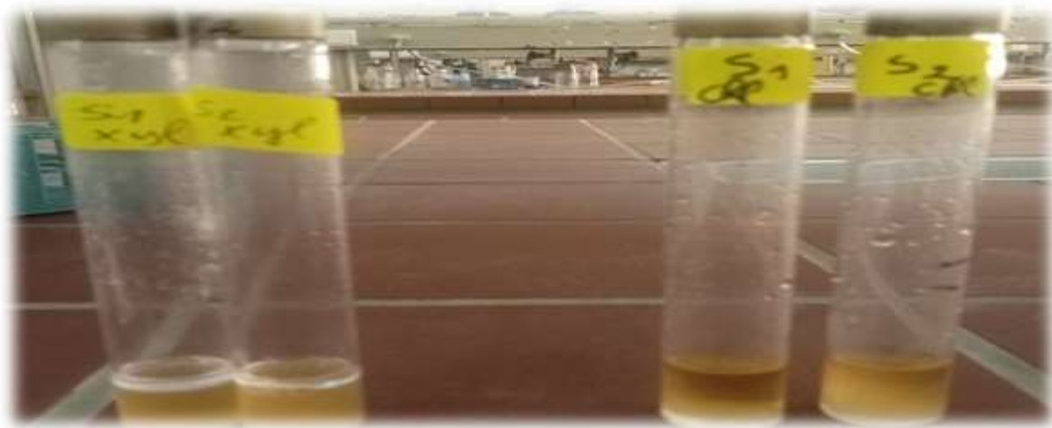
Figure 10 : Test d'hydrophobicité avec le chloroforme et le xylène.
