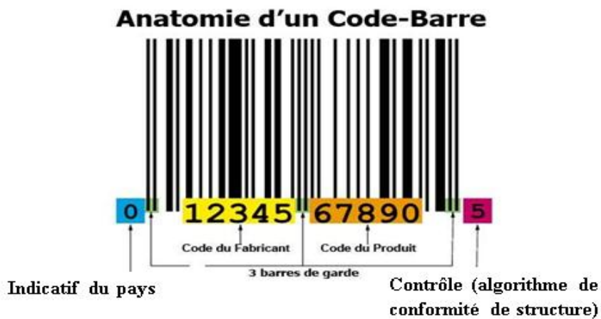
Figure n° 04: la structure d'un code à barre
