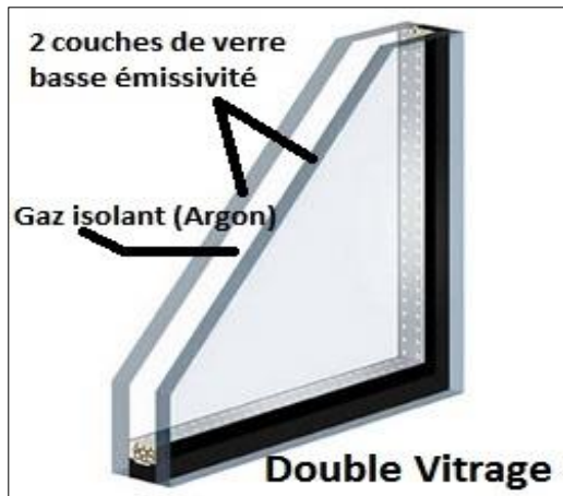
Figure II. 20: Double vitrage à ossature PVC Source : http://conseils-thermiques.org/contenu/choisir_fenetres.ph
