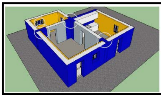
Figure 21 : repérage des ponts thermiques. Source : RénoVACT.
