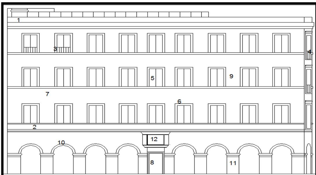
Figure 71: les éléments constructifs de l'immeuble
