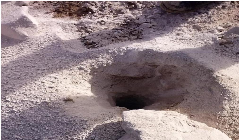
**Figure IV.7 :** Trous forés à la carrière El Ouldja (15/03/2017).
