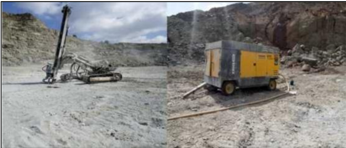
Figure V.3 : Chariot de foration et compresseur mobile. (Photo carrière de Si-Mustapha)
