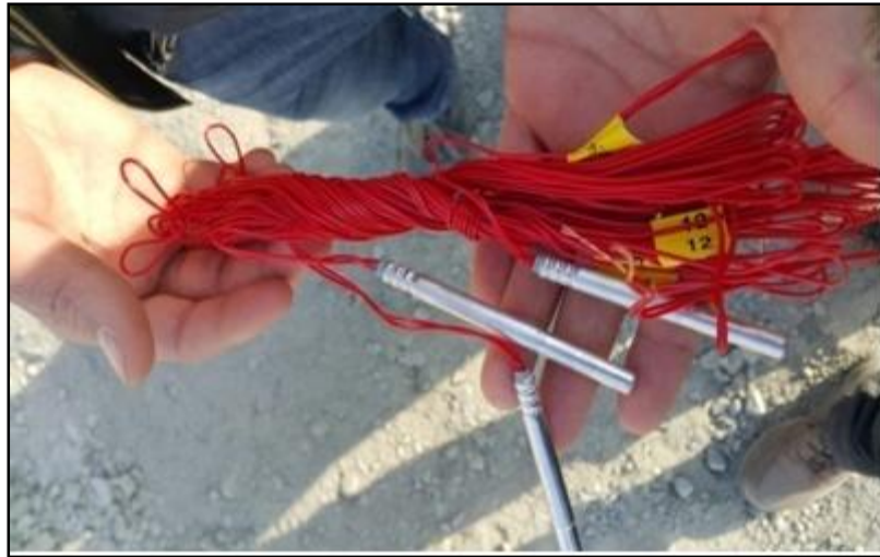
Figure IV. 2 : Détonateurs électriques Micro-Retard DMR.
