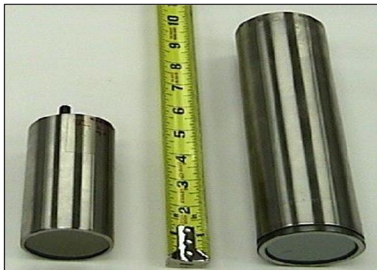
Figure I.04 : Détecteur de scintillation d'un outil de mesure de gamma ray (Halliburton, 2006).
